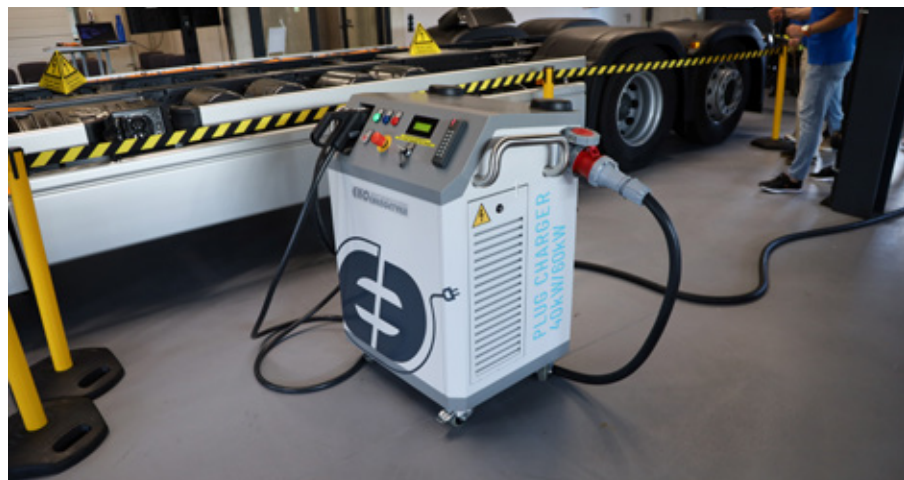
Partnerem Daimler Truck Polska w elektryfikacji flot jest firma Ekoenergetyka dostarczająca ładowarki w szerokim zakresie mocy: 22 kW AC do ładowania nocnego, kilka rodzajów przewoźnych urządzeń 40 i 80 kW, stacjonarne aż do 400 kW.
