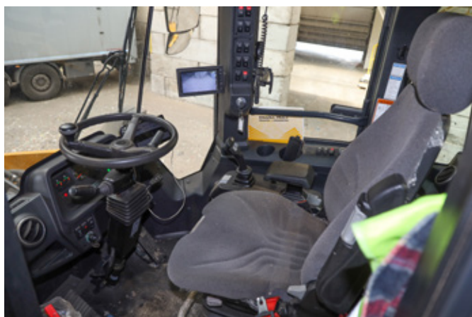
Wysoko umieszczona kabina gwarantuje dobrą widoczność wokół maszyny. Wnętrze jest znacznie bardziej przestronne niż w ładowarkach teleskopowych, co polepsza komfort pracy.
