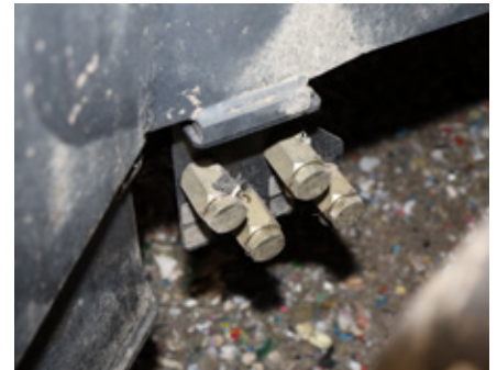
Aby uprościć obsługę ładowarki, spusty oleju silnikowego, hydraulicznego, przekładniowego oraz płynu chłodniczego zostały umieszczone w jednym miejscu, po prawej stronie maszyny.
