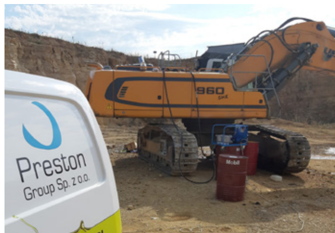
Filtrowanie oleju hydraulicznego jest szczególnie polecane w maszynach budowlanych i rolniczych, pracujących na zewnątrz, przy dużym zapyleniu i wilgotności. Można w ten sposób uniknąć przedwczesnej wymiany oleju, a tym samym oszczędzić na kosztach zakupu i utylizacji, ale przede wszystkim wydłużyć żywotność cennego sprzętu.
