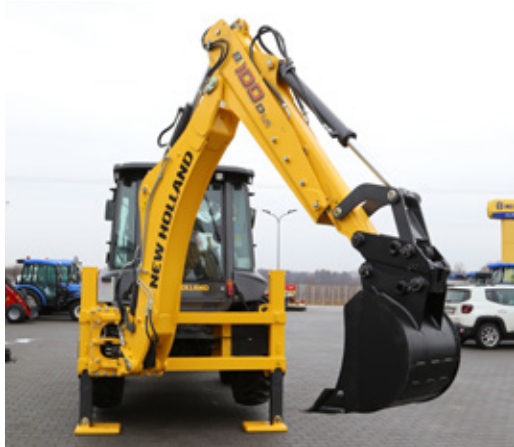
Ramię koparkowe może być stałe lub teleskopowe. Sifowniki umieszczone w linii zapewniają lepszy rozkład naprężeń i znakomitą widoczność osprzętu.
