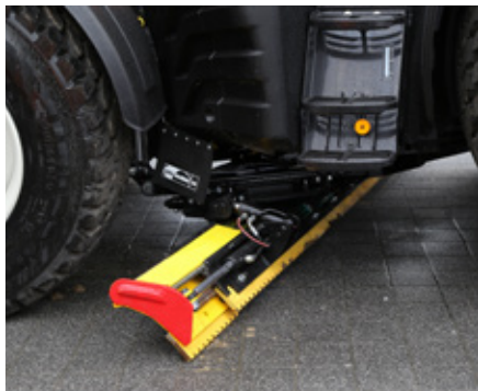
Zgarniacze Arctic montowane centralnie są przeznaczone do całorocznego utrzymania dróg: odśnieżania, usuwania zbitego lodu i śniegu w ziemię oraz profilowania żwiru i wyrównywania nawierzchni dróg leśnych w miesiącach letnich.
