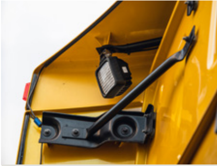
Lampy WESEM są dostępne w różnych wersjach, jeśli chodzi o sposób montażu, ułatwiając ich odpowiednie zamocowanie w dowolnym miejscu podwozia lub zabudowy.
