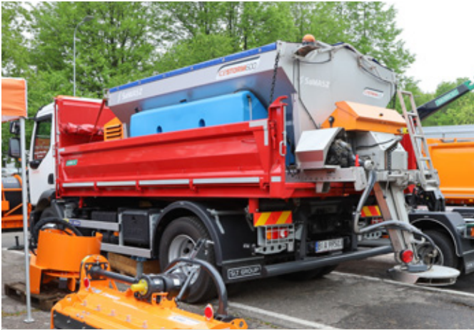
Talerz rozrzucający ma średnicę 600 mm i jest wyposażony w 8 wymiennych łopatek. Szerokość sypania można regulować w zakresie od 1,5 do 12 m.
