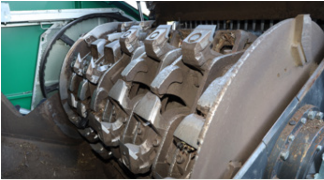
Tzw. rampy ustalające umieszczone między rzędami zębów określają grubość materiału, jaka ma być skrawana podczas pojedynczego przejścia elementu tnącego.
