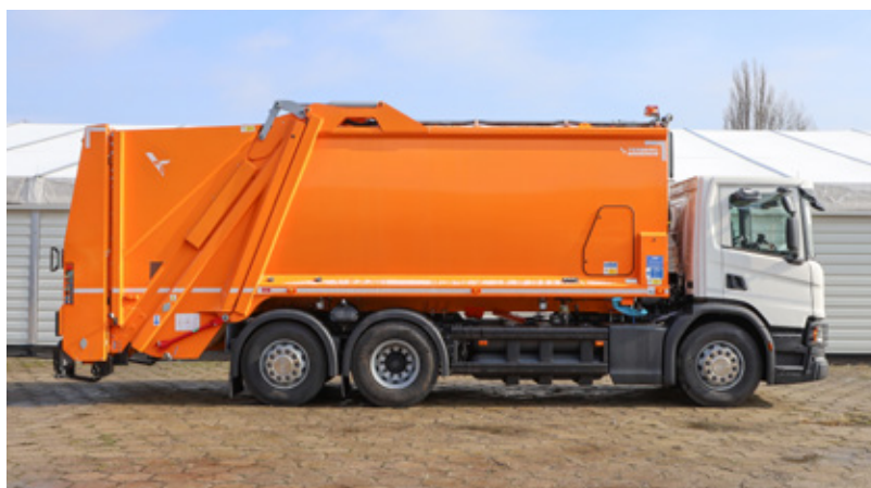
Prezentowany pojazd tworzy zabudowa Olympus TwinPack o pojemności 22 m 3 z wrzutnikiem UPC, zamontowana na podwoziu Scania P340 CNG o rozstawie osi 3950 mm.
