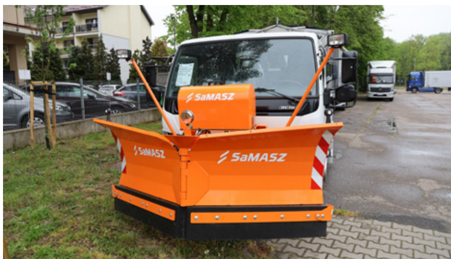
Zależnie od modelu pług może być wyposażony we własny układ hydrauliczny, niezależny od podwozia. Takie rozwiązanie zapewnia szybkie i precyzyjne sterowanie osprzętem.
