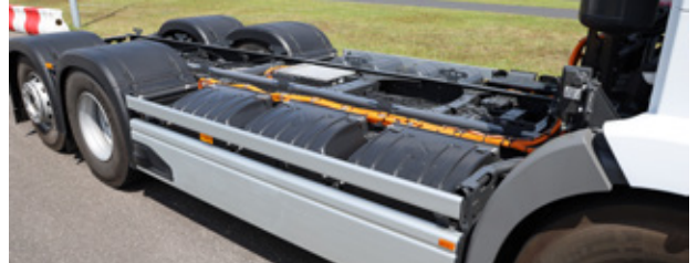
Koncern Daimler Truck wybrał do elektrycznych ciężarówek ogniwa litowo-jonowe typu NMC, starannie zabezpieczając je przed samoistnym zapłonem na skutek „rozbiegania cieplnego”, które może nastąpić w razie zwarcia spowodowanego np. uderzeniem w baterię.
