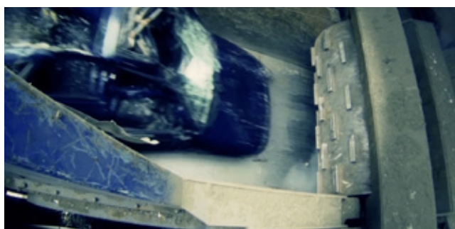
Odporne na pęknięcia i zużycie obudowy wykonane z hartowanej stali Hardox HiTuf zwiększają trwałość rozdrabniaczy, a tym samym zyski użytkowników i ich reputację.
