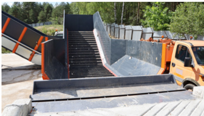
Przednia część bufora załadunkowego ma kształt szerokiego leja, w którym mieści się odwrót śmieciarki.
