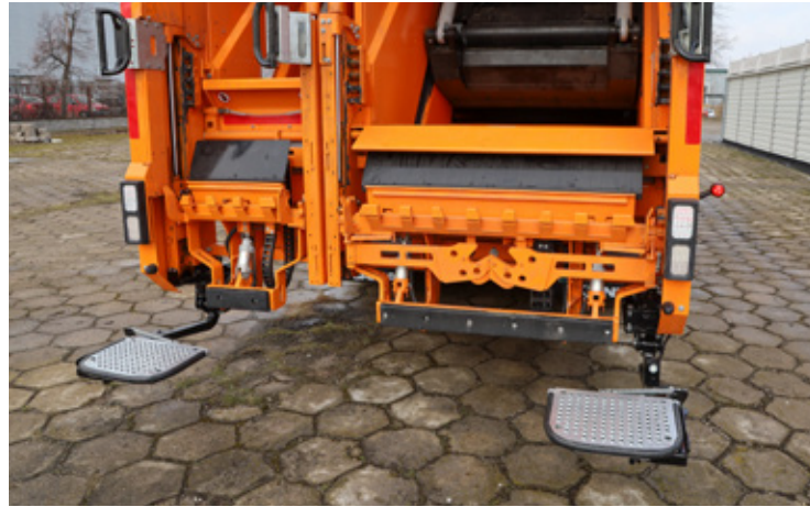
Opuszczane burty ułatwiają ręczny załadunek odpadów, np. gromadzonych w workach.
