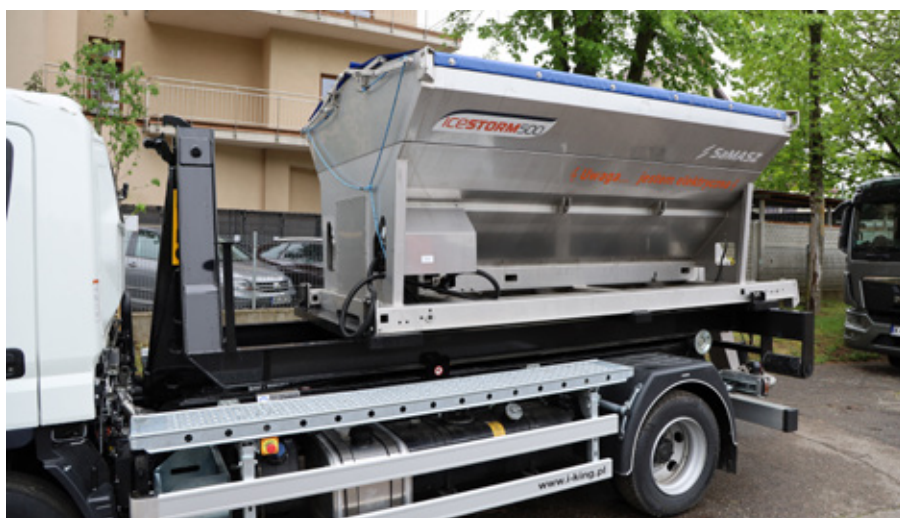
Już w standardowej kompletacji posypywarki SaMASZ są w całości wykonywane ze stali nierdzewnej, co zwiększa trwałość urządzeń w kontakcie z materiałami uszorstniającymi.
