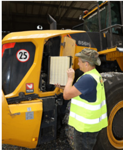
Przemysłana konstrukcja zapewnia wygodny dostęp do punktów wymagających kontroli i obsługi. Stan filtra powietrza można szybko sprawdzić przez dodatkowe drzwiczki – nie trzeba w tym celu podnosić pokrywy silnika.
