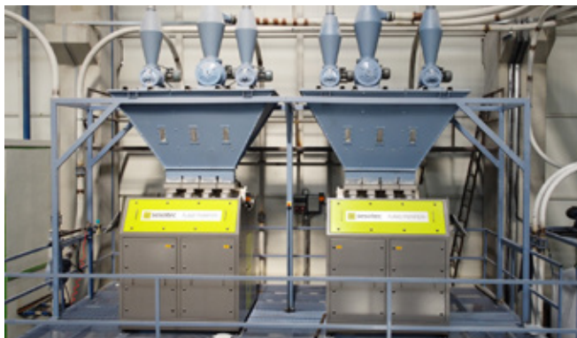
Optosorter Flake Purifier należy do serii urządzeń przesypowych pracujących z materiałami rozdrobnionymi. Służy do sortowania i oczyszczania tworzyw sztucznych w postaci np. płatków czy granulek.
