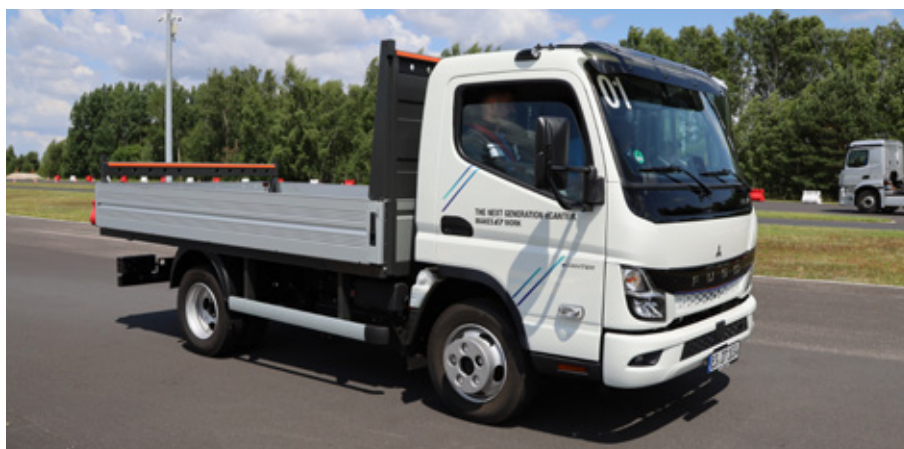
FUSO Canter był tym modelem koncernu, który przecierał elektryczne szlaki najpierw w wersji hybrydowej, następnie w dwóch generacjach elektrycznych. Teraz wchodzi w zupełnie nowej postaci, wyposażony w modułowe zasilanie elektryczne ułatwiające zmieszczenie się w limicie DMC 4,25 t.
