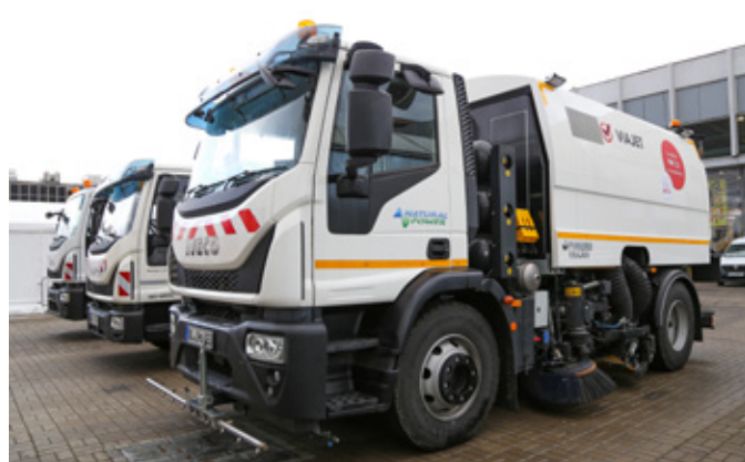
Podwozia IVECO Eurocargo NG są przygotowane do roli śmieciarki, hakowca, a nawet zmiatarki. Te ostatnie nie wliczają się niestety do limitu ujętego w Ustawie o elektromobilności.
