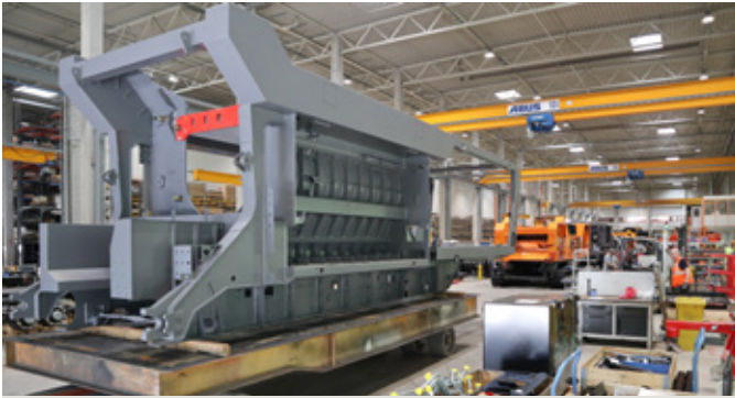
W nowej hali pracuje ok. 50 osób na zmianę, montując średnio dwie maszyny dziennie, w sześciu taktach produkcyjnych. Ta nawa jest przeznaczona na rozdrabniacze, przesiewacze mają osobną linię.
