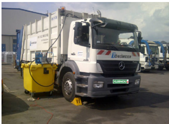
Zanieczyszczenie oleju hydraulicznego wodą wpływa na ścisłość i wydajność, zmniejsza również smarowność i może prowadzić do powstawania szlamu w układzie. Jednak największym problemem jest to, że woda powoduje korozję o nieodwracalnych skutkach.
