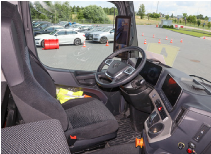
Standardem wyposażenia eActrosów jest zelektronizowana, multimedialna tablica rozdzielcza. Kabina jest cicha, poziom drgań jest znacznie mniejszy niż w dieslach.
