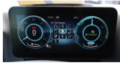
Nowoczesny interfejs przekazuje kierowcy czytelne dane dotyczące zasięgu i przepływów energii, ułatwiając ekonomiczną jazdę.
