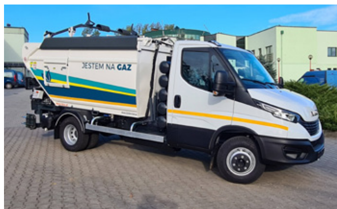
Każdy gazowy IVECO Daily ma butle CNG montowane w przestrzeni podwozia. Dokłada się jeszcze zestaw na pionowym stelażu za kabiną, jeśli zasięg ma być szczególnie duży.
