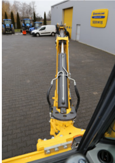
Ramię koparkowe może być stałe lub teleskopowe. Sifowniki umieszczone w linii zapewniają lepszy rozkład naprężeń i znakomitą widoczność osprzętu.
