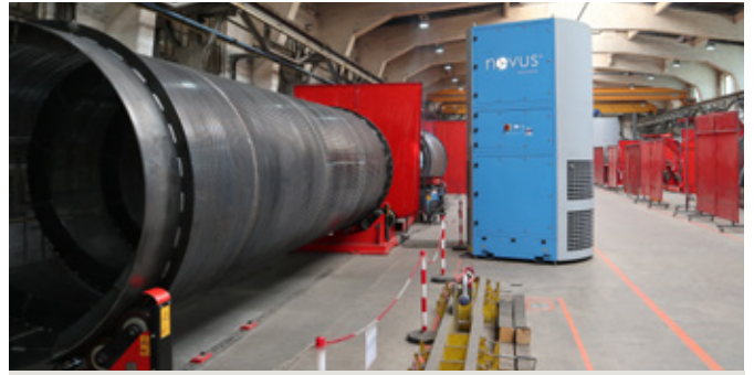
W halach, które najtrudniej było poddać modernizacji ulokowano procesy mniej wymagające pod względem przestrzeni, np. zawijanie i spawanie bębnow do przesiewaczy. Dobre warunki pracy zapewniają kolumny filtracyjne.
