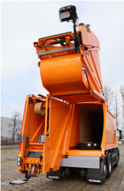
W zabudowach Olympus TwinPack są dostępne różne podziały komór, umożliwiając dostosowanie pojazdu do ilości konkretnych odpadów na danym rejonie.
