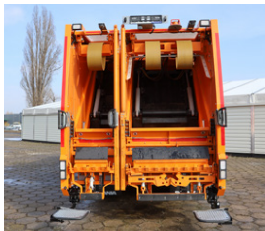
Wrzutnik UPC ma jednocześnie grzebienie ładunkowe po obu stronach i jest sterowany ręcznie.
