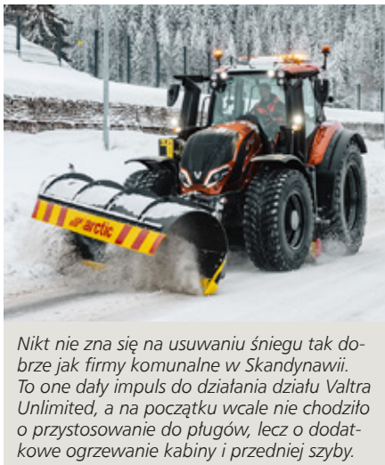
Zgarniacze Arctic montowane centralnie są przeznaczone do całorocznego utrzymania dróg: odśnieżania, usuwania zbitego lodu i śniegu w ziemię oraz profilowania żwiru i wyrównywania nawierzchni dróg leśnych w miesiącach letnich.
