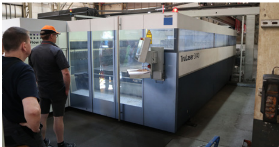
Blacha stalowa jest kierowana na wypalarki laserowe lub plazmowe, zależnie od grubości, skąd wycięte elementy są rozprawdane na ręczne lub zrobotyzowane stanowiska spawalnicze.
