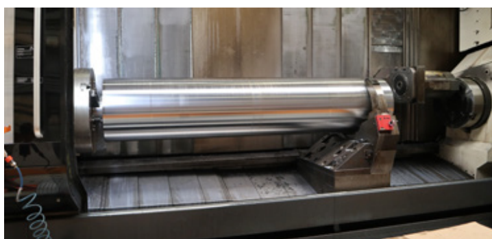
Obrabianie wałów o dużej średnicy jest specjalnością Calbe od początku istnienia zakładu. Nowy właściciel zainwestował w najnowsze tokarki: na tej można przygotować wał o długości 5 m i średnicy do 1 m, a wcale nie jest ona największą jaką została tu zainstalowana.
