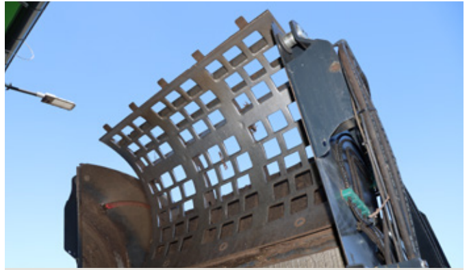
Producent zapewnia szeroką gamę koszy klasyfikacyjnych, ułatwiających dobór elementu do rodzaju przetwarzanego materiału.
