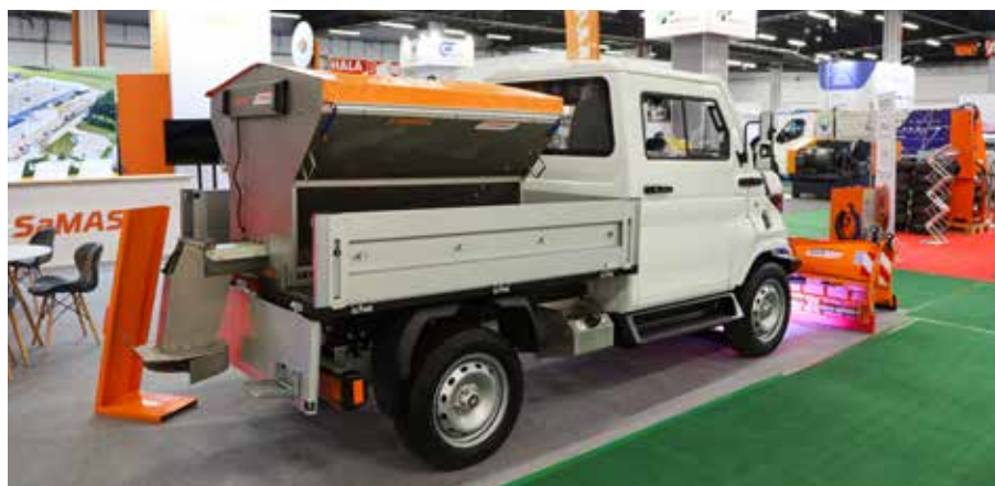
Dzięki niewielkim gabarytom posypywarka IceSTORM e80 może być zamontowana na pickupie, przyczepce samochodowej czy nawet w samochodzie dostawczym.
