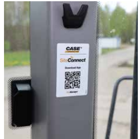
Najnowsze ładowarki CASE są wyposażone w rozwiązanie SiteConnect, które umożliwia (za zgodą właściciela maszyny) komunikację dwukierunkową między maszyną a dealerm w celu m.in. zdalnej diagnostyki sprzętu.
