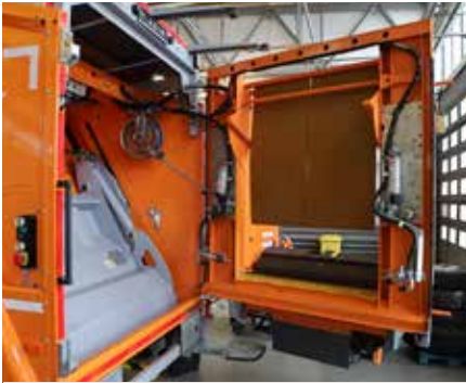
Otwierana na bok brama DIN zapewnia idealny dostęp do mechanizmu prasy oraz systemu myjącego. W głębi jest widoczne zwijadło z węzłem do zasilania lancy wysokociśnieniowej.
