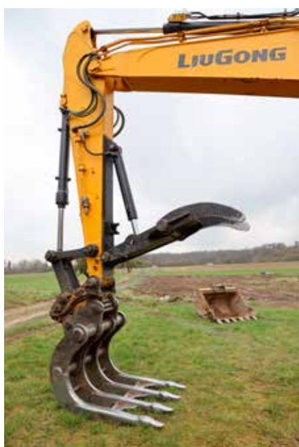
Ażurowa łyżka z tzw. kciukiem to podstawowy osprzęt wykorzystywany z koparką 922E. Umożliwia karczowanie drzew oraz ich przymowanie i załadunek do rozdrabniacza.
