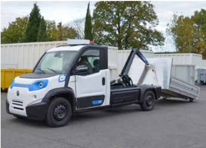
Wobec ponad 1100 kg nośności i dłuższej ramy modelu G6, hakowe urządzenie ładunkowe wręcz narzucało się jako najlepszy sposób na uniwersalne wykorzystanie nowego Goupila.
