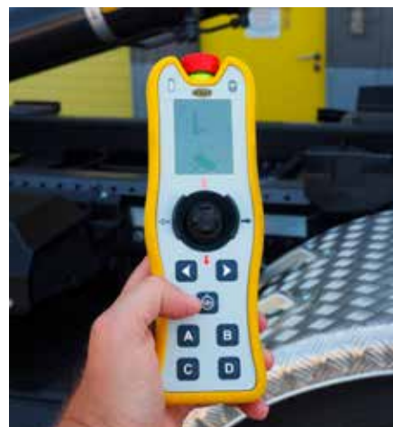
Wstępne zaprogramowanie procedur w sterowniku Meiller i.s.a.r.-control umożliwia zaoszczędzenie czasu, znacząco przyspieszając obsługę.
