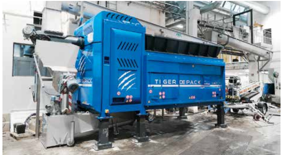
Maszyny Tiger Depack mają pionowo umieszczony wał roboczy, dzięki czemu cała konstrukcja jest bardziej zwarta i łatwiej znaleźć dla niej miejsce.
