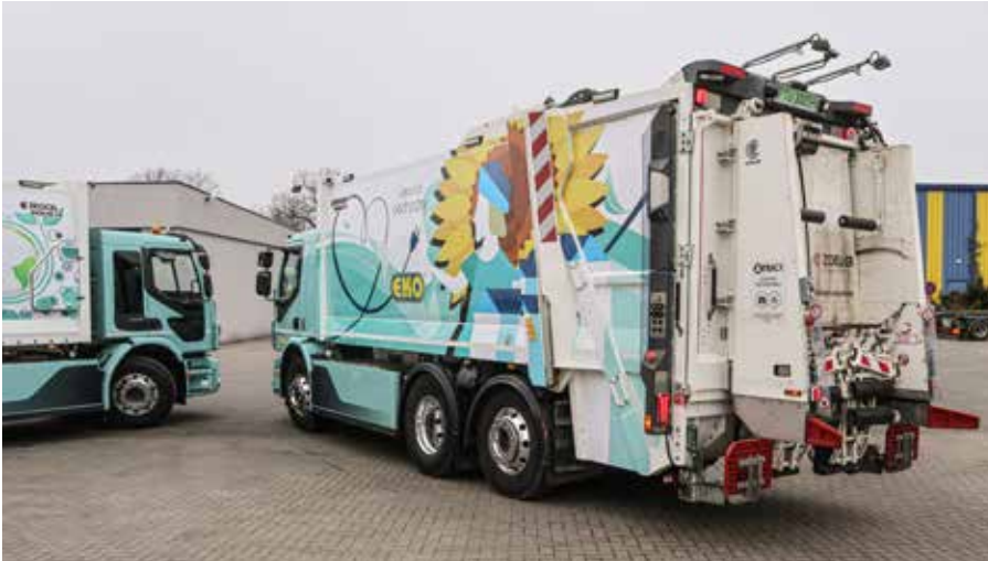
Obie elektryczne śmieciarki mają identyczne zabudowy Ekocel Medium X4 maksymalnie skrócone na tylnym zwisie, ale o małym kącie pochylenia tylnej ściany. W ten sposób poprawiono rozkład mas na osie nie tracąc na pojemności skrzyni ładunkowej.
