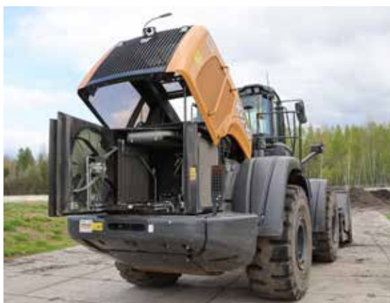
Chłodnice są ustawione w sześcian, dzięki czemu każda z nich ma odpowiedni dostęp powietrza.
