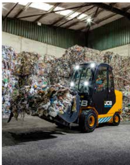
Wózek Teletruk wyposażony w łyżkę może pełnić rolę ładowarki załadującej odpady np. na linię technologiczną.
