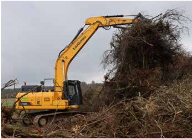
Koparka LiuGong 922E wyposażona w osprzęt tworzący praktyczny chwytak doskonale radzi nastroszonym materiałem. Maszyna podwozi gałęzie pod rozdrabniacz a następnie załaduje je do nadawy.
