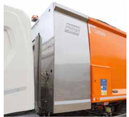
Moduł zbiorników ma kształt dopasowany do skrzyni zabudowy. W jego dolnej części znajduje się zbiornik na wodę brudną, w górnej – na wodę czystą.
