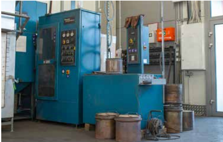
Filtry cząstek stałych, które nadają się do regeneracji trafiają na maszynę Hartridge DPF 300. Cały proces oczyszczania odbywa się na sucho.
