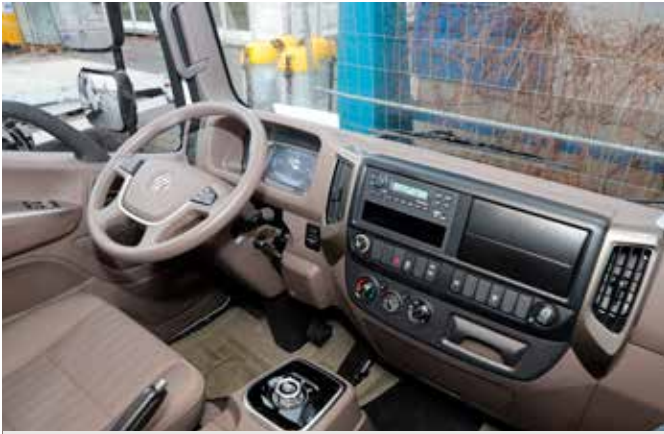
Tablica rozdzielcza nie wnika do wnętrza, co ułatwia przechodzenie na drugą stronę kabiny. Niska krawędź szyby czołowej oraz bocznych będą pomocne podczas manewrowania w ograniczonej przestrzeni.
