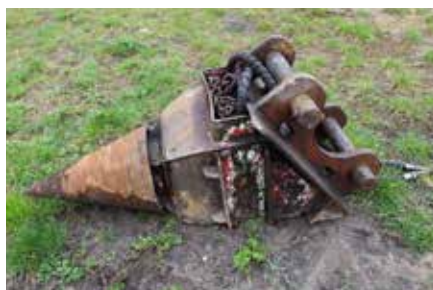
Jeśli drzewo jest zbyt grube, operator rozłupuje je na dwie lub cztery części za pomocą hydraulicznej łuparki stożkowej.
