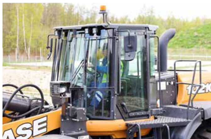
Większa ładowarka CASE będzie wykorzystywana do pracy z gruzem, dlatego przód kabiny wyposażono w solidne zabezpieczenia.
