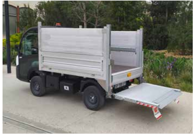
Goupil G4 może przewozić np. maszyny do utrzymania zieleni pomiędzy kolejnymi miejscami w obsługiwanym regionie, lecz jak umieścić je na skrzyni? Odpowiedzią jest lekka winda kolumnowa o nośności 500 kg.
