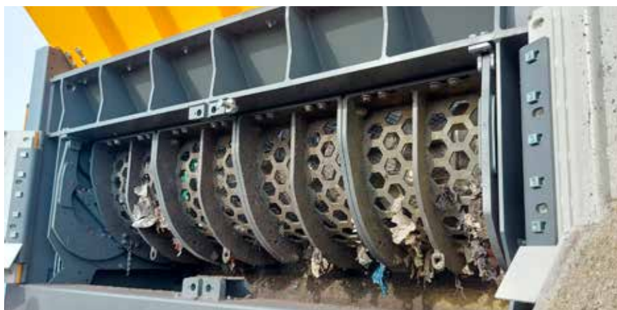
Sito definiujące frakcję wyjściową składa się z czterech połączonych ze sobą sekcji. Cały zespół jest hydraulicznie wysuwany na zewnątrz maszyny, dzięki czemu łatwo go wówczas podnieść np. wózkami widłowymi i zamienić na inną wersję.
