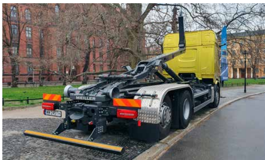
Urządzenie może zostać skonfigurowane do pracy z kontenerami DIN-owskimi lub niespełniającymi tej normy. Jest to cecha bardzo pożądana dla przewoźników pracujących dla wielu klientów z różnymi kontenerami.
