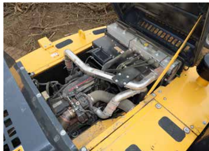
Maszyna LiuGong 922E ma masę eksploatacyjną ok. 23 tony. Źródłem napędu koparki jest 6-cylindrowy silnik Cummins o pojemności 6,7 dm 3 . Jednostka ta osiąga moc 119 kW (162 KM), pozwalając na dynamiczną i efektywną pracę.
