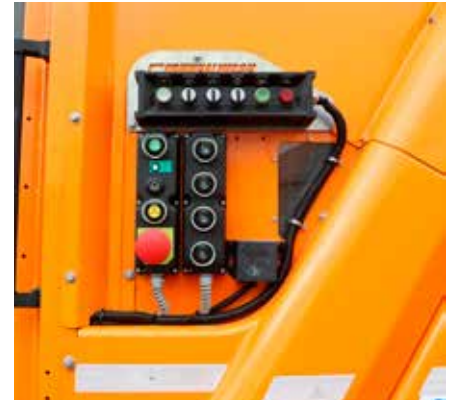
Do obsługi systemu myjącego służy niewielki poziomy panel zamontowany nad przyciskami do sterowania pracą zabudowy.
