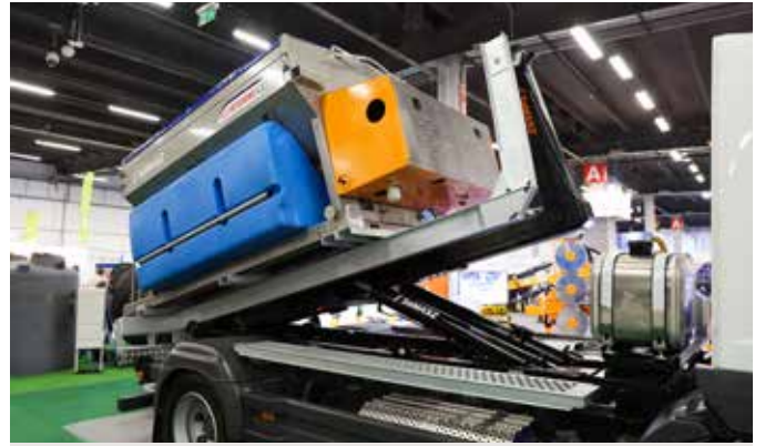
Skrzynia ładunkowa każdej posypywarki IceSTORM jest wykonana ze stali nierdzewnej. Sterowanie wszystkimi funkcjami maszyny odbywa się za pomocą pulpitu umieszczonego w kabinie pojazdu.
