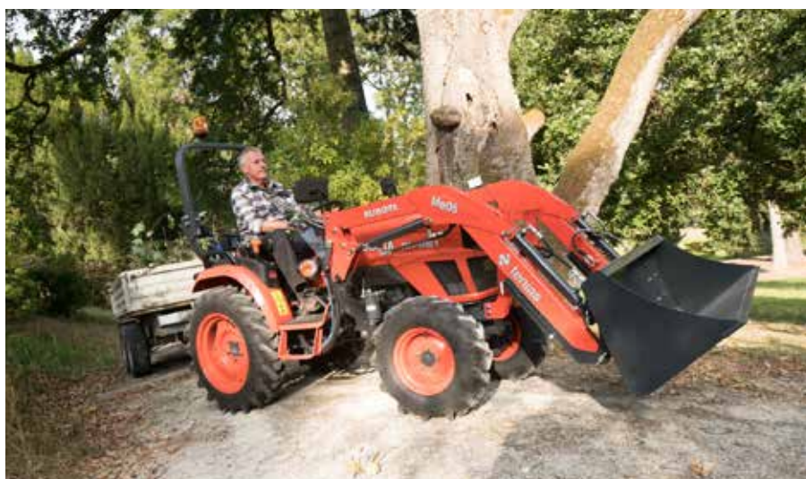
Miniciągnik Kuboty ma włączany napęd 4x4, blokadę mechanizmu różnicowego tylnego mostu i prześwit 310 mm, dzięki czemu bez trudu pokona nawet zaśnieżone lub rozmokłe drogi gruntowe.
