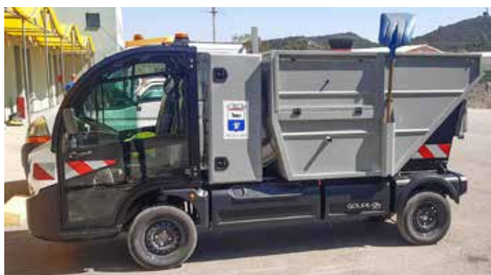
Duża nośność podwozia G4 umożliwia zabudowę skrzynią podnoszoną hydraulicznie na podwyższonej osi, tak, że odpady są wysypywane do kontenera lub do odwłoka większej śmieciarki. Dłuższy G4L zmieści za kabiną także skrzynię na sprzęt.
