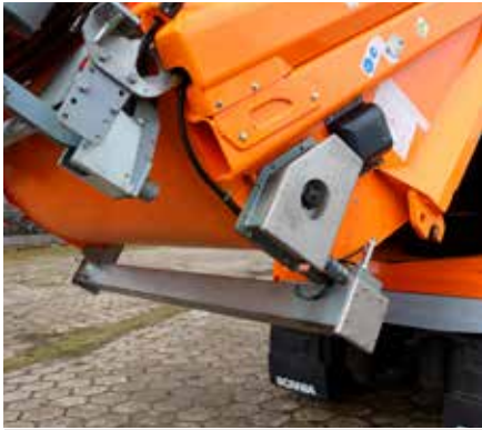
Budna woda przechodzi najpierw przez separator (skrzynka z boku odwłoka) i spływa do prostopadłościennego, podłużnego zbiornika tymczasowego umieszczonego pod odwłokiem.
