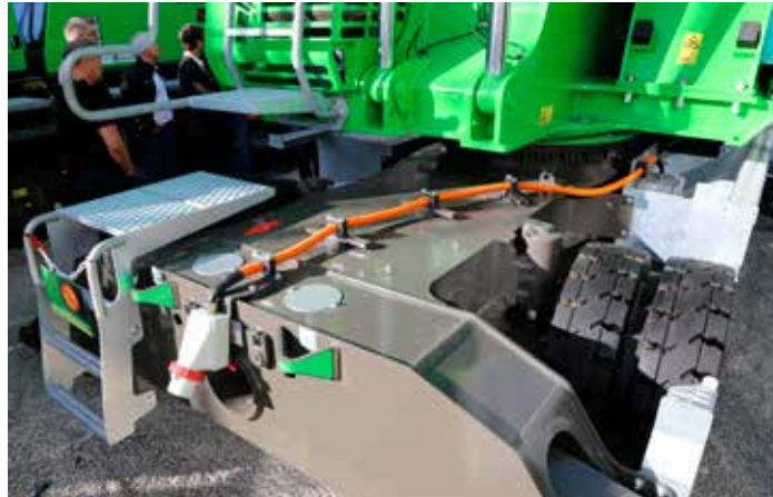
Możliwość podłączenia koparki do typowego gniazda siłowego zapobiega konieczności zakupu zewnętrznej ładowarki.
