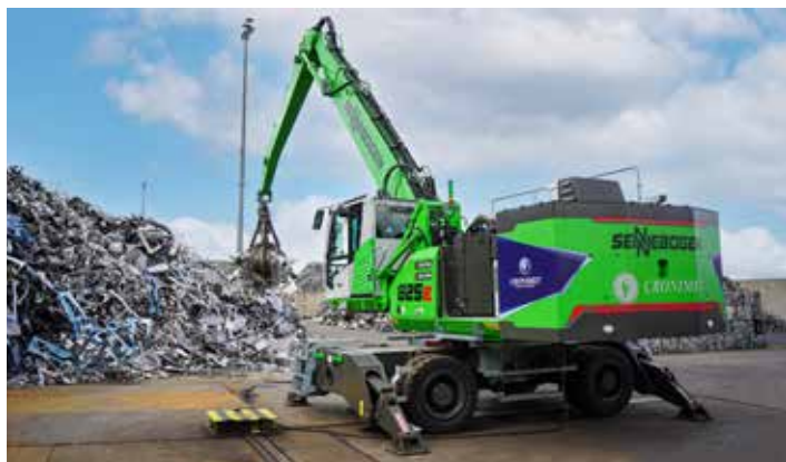
Model 825M-E zasilany akumulatorowo jest napędzany silnikiem elektrycznym o mocy 110 kW. Przy braku zewnętrznego zasilania źródłem energii są akumulatory umieszczone w miejscu przeciwwagi.
