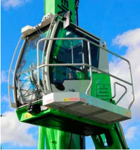
Szeroki podest z barierką i przesuwne drzwi kabiny Maxcab zapewniają maksymalne bezpieczeństwo podczas wchodzenia i wychodzenia z maszyny.
