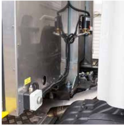
Aby dodać detergent do czystej wody wystarczy zanurzyć wąż w kanistrze i nacisnąć widoczny przycisk.
