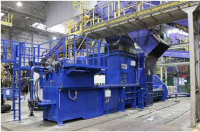
Maszyna została wyposażona w drabinkę oraz komplet szerokich podestów z barierkami, zapewniając bezpieczną obsługę wysoko umieszczonych podzespołów.
