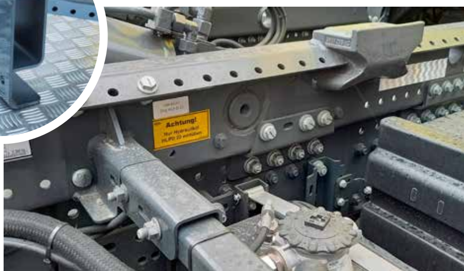
RS21 jest montowany na ramie pojazdu połączeniami śrubowymi, przy wykorzystaniu siatki otworów wykonanych fabrycznie w ramie urządzenia o charakterystycznym przekroju. Dzięki wyeliminowaniu spawania wsporników można było zabezpieczyć hakowiec przed korozją metodą gruntowania kataforetycznego.
