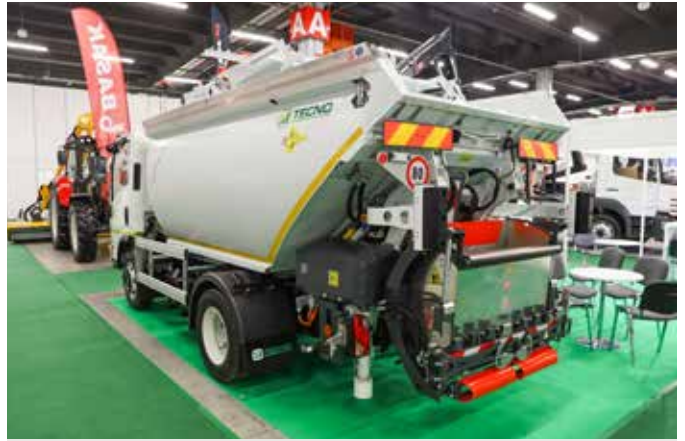
W zaprezentowanej śmieciarce Azimut zastosowano elektryczny napęd mechanizmów zabudowy, który pozwala na zaoszczędzenie nawet 30% paliwa. Kosz zintegrowany z wrzutnikiem zapobiega wysiłkowi przy załadunku odpadów wrzucanych ręcznie, np. w workach.
