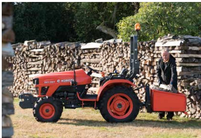
Tylny TUZ zapewni udźwieg 750 kg. W pracy przez cały rok pomoże reflektor roboczy.
