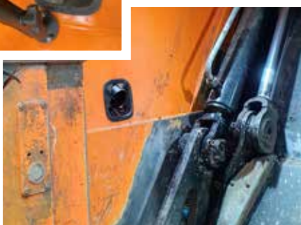
Kamery w bocznej ścianie odwłoka wykrywają zanieczyszczenia w momencie opróżniania pojemnika.
