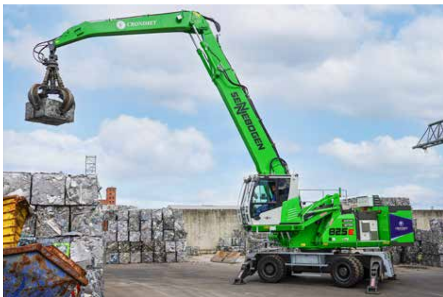
Brak iskrzenia i emisji szkodliwych gazów pozwala na stosowanie maszyny elektrycznej w branży recyklingowej, drzewnej oraz zamkniętych halach.
