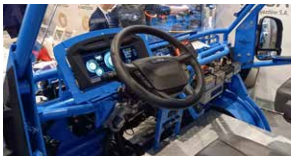
Platforma ma kompletną instalację elektryczną oraz nowoczesną tablicę rozdzielczą z ciekłokrystalicznymi wskaźnikami.
