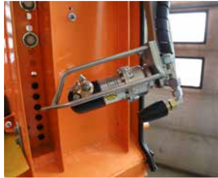
Obie obrotowe głowice myjące mają po 4 dysze dla dokładnego i szybkiego mycia całej powierzchni pojemnika. Poniżej znajduje się tzw. turbodysza usuwająca zabrudzenia przyklejone do dna.
