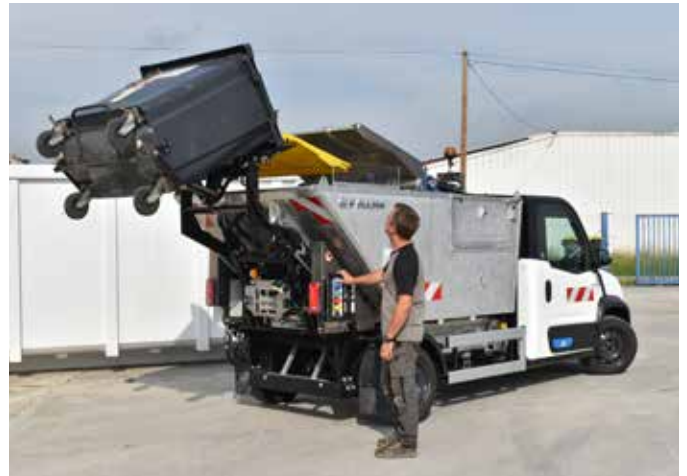
Kolejne rozwiązanie już sprawdzone w praktyce to zabudowana na podwoziu G6 lekka, aluminiowa skrzynia na opady wysypywane do kontenera. W tym przypadku można uzupełnić ją o płytę zagęszczającą.
