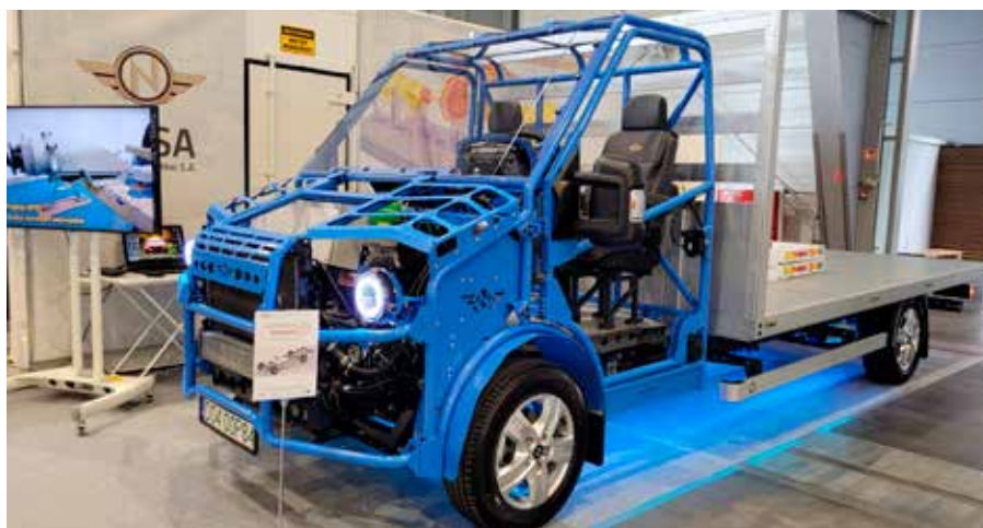
Pierwsze wysiłki biura konstrukcyjnego poświęcono skonstruowaniu elektrycznej platformy jezdnej wykorzystującej lekką ramę podłużnicową i opatentowane przednie zawieszenie na podwójnych wahaczach z poprzecznym resorem. Przystosowano ją do łatwiej integracji z kabiną i każdym nadwoziem.
