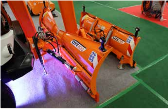
Pługi serii Lite oraz City zaprojektowano z myślą o obsłudze chodników, małych bocznych dróg, placów oraz parkingów.
