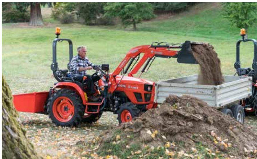
Ładowacz czołowy jest jedną z opcji osprzętu. Łyżka ma pojemność 120 l, a zakres pracy umożliwia wykorzystanie jej do płytkiego kopania: to idealne rozwiązanie przy budowaniu małych parków czy placów zabaw.
