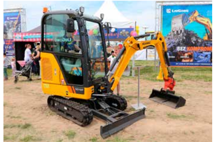
Maszyna 9018F to najmniejsza minikoparka w gamie LiuGong. Ma masę eksploatacyjną 1900 kg i zapewnia głębokość kopania 2,43 m. Standardem jest hydraulicznie rozsuwane podwozie w zakresie od 980 do 1290 mm (szerokość mierzona na zewnątrz gąsienic).
