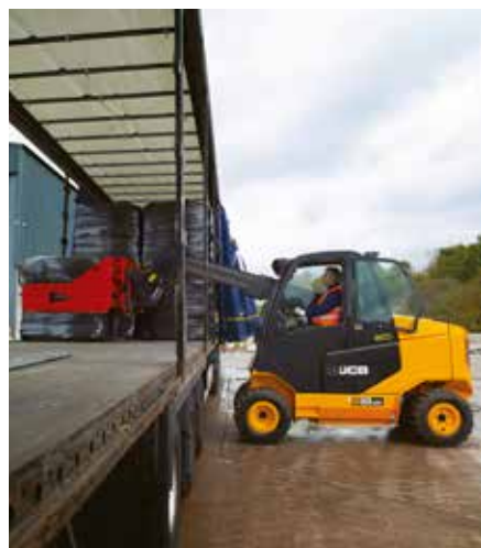
Ładunek zestawu naczepowego z jednej strony umożliwia zaoszczędzenie ok. 70 m 2 placu manewrowego. Krótszy jest też czas całej operacji oraz mniejsze zużycie paliwa lub energii elektrycznej.
