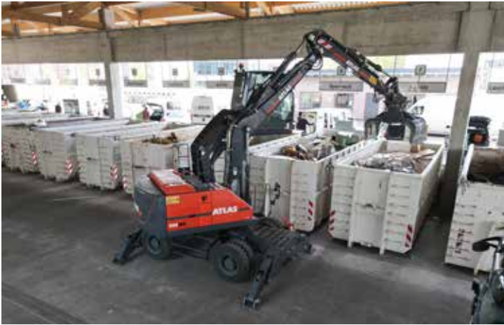
Maszyna przeładunkowa ATLAS 200 MH accu łączy zalety napędu elektrycznego z autonomią klasycznego sprzętu tego typu. Na zdjęciu egzemplarz dostarczony do zakładu miejskiego przedsięwzięcia oczyszczania w Hamburgu.
