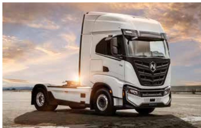
Od jesieni ub. roku przyjmowane są zamówienia na bateryjne ciągniki Nikola Tre BEV. W dwuosioowym podwoziu zmieszczono akumulatory o pojemności 738 kWh, co starcza na przejechanie do 500 km. Napęd stanowi oś ze integrowanym silnikiem elektrycznym o mocy ciągłej 480 kW.
