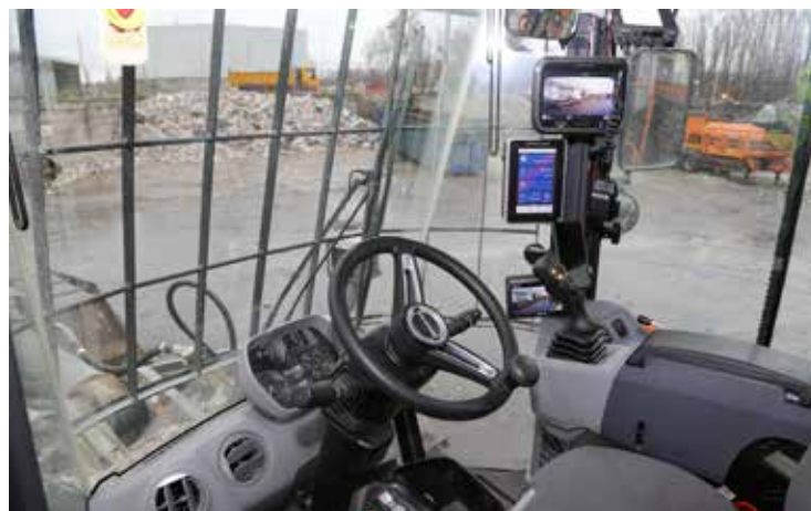
Obie duże ładowarki mają zainstalowaną wagę do pomiaru masy materiału, jaki jest nabierany do łyżki, co pozwala na prawidłowy załadunek zestawów naczepowych.
