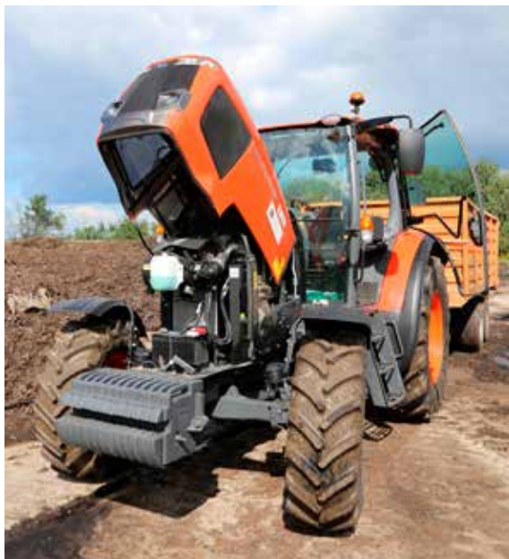
Dzięki jednoczęściowej, szeroko otwieranej pokrywie silnika prostsze i szybsze są zarówno codzienna obsługa maszyn Kubota, jak i przeglądy czy naprawy w serwisie. Operator i mechanik mają łatwy dostęp do chłodnicy, filtrów czy akumulatora.
