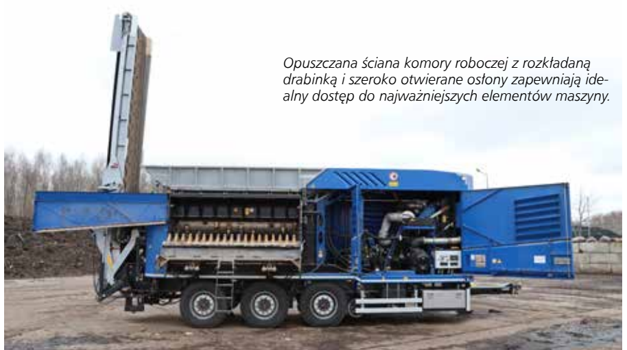
Przeñośnik wyrzutowy jest opuszczany do poziomu, co pozwala na wysunięcie przeñośnika umieszczonego pod wałem roboczym. Dzięki temu łatwo go czyścić i przeprowadzać czynności konserwacyjne.
