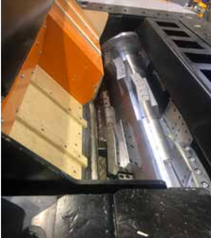
Lity wał roboczy jest wyposażony w proste noże z czterema ostrzami do wykorzystania. Maszyna może mieć jedną lub opcjonalnie dwie listwy z przeciwnożami.
