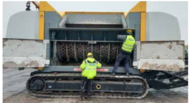
Podczas pokazów specjaliści UNTHA Polska nie tylko prezentują możliwości rozdrabniacza XR mobil-e, ale również jego obsługę, w tym wymianę sit, które definiują produkt końcowy.
