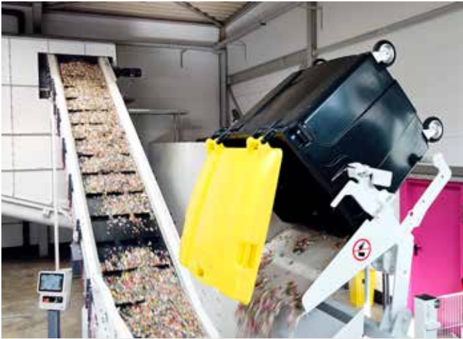
Na linię technologiczną trafia wstępnie rozdrobniony materiał, pozbawiony zanieczyszczeń ze stopów żelaznych.
