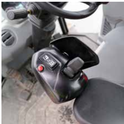
Dodatkowe sterowanie skrętem maszyny za pomocą ergonomicznego joysticka należy do wyposażenia standardowego. Unikanie rozwiązań ułatwia pracę i zmniejsza wysiłek operatora przy często powtarzanych manewrach.
