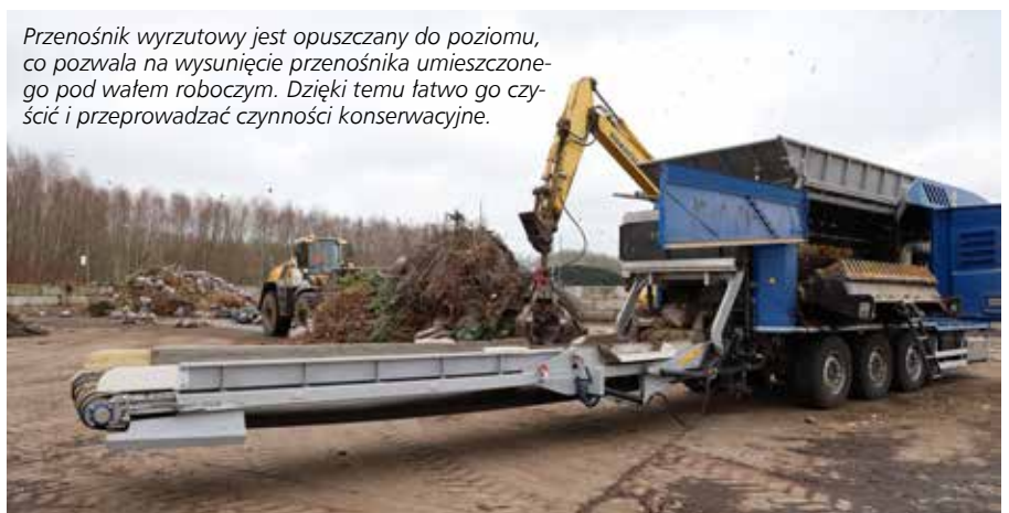
Maszyna dostarczona do Eko Doliny ma system zraszania ograniczający pylenie – żółty przewód doprowadza wodę pod ciśnieniem. Lampki oświetlające komorę roboczą to jeden z wielu przykładów dbałości o detale.
