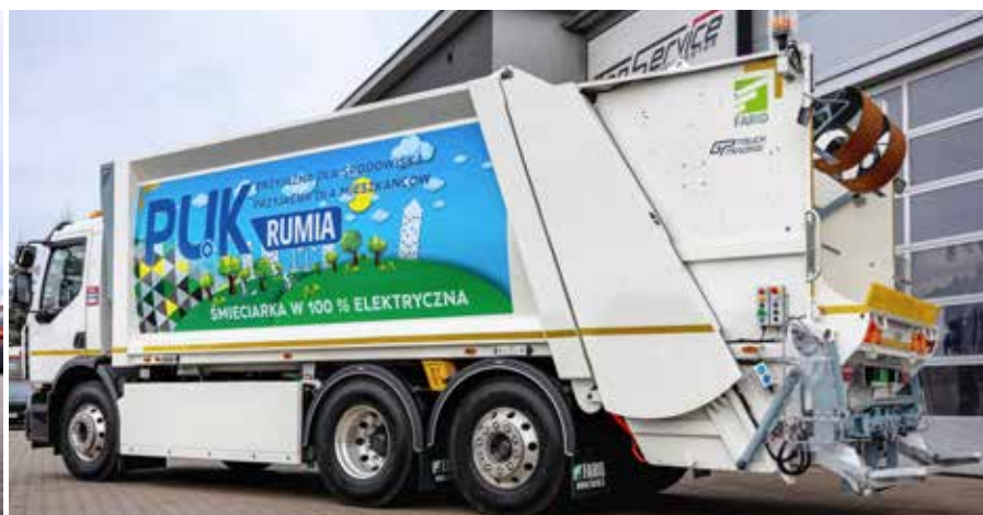
Zabudowa Farid T1 Plus zapewnia maksymalny stopień zgniotu 6:1 i jest przeznaczona do zbierania stałych odpadów komunalnych, surowców wtórnych oraz tzw. wielkogabarytów.
