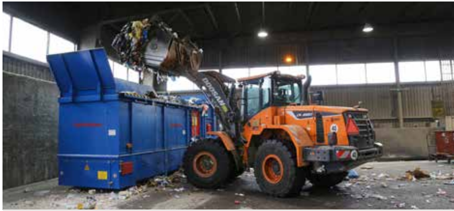
Ładowarka Doosan DL220-5 idealnie sprawdza się w hali nadawczej, m.in. przy załadunku odpadów do rozrywarki worków. Zastosowano w niej łyżkę z dociskiem, dzięki czemu w każdym cyklu można nabrać więcej materiału.
