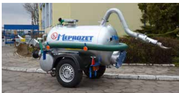
Podlewanie zieleni będzie odbywało się za pomocą łyżki rozlewowej zamontowanej na końcu przewodu doprowadzającego wodę pod ciśnieniem.
