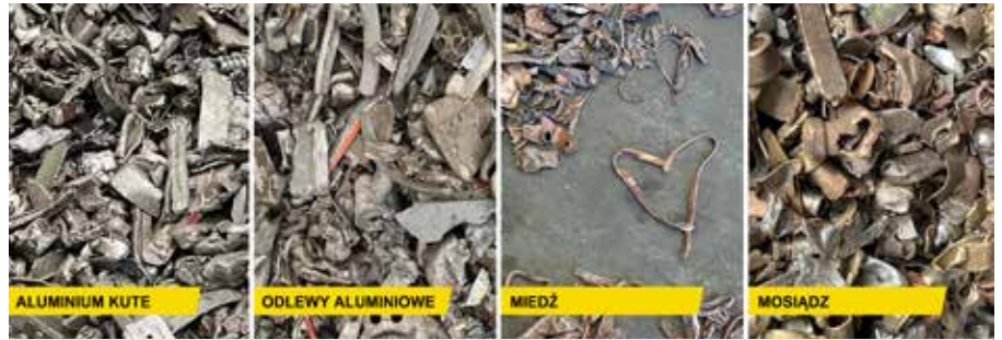
Produkty nadające się do bezpośredniego przetopienia w odlewniach i hutach aluminium, miedzi lub mosiądzu.
