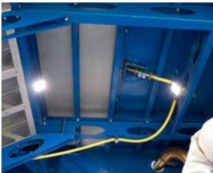
Maszyna dostarczona do Eko Doliny ma system zraszania ograniczający pylenie – żółty przewód doprowadza wodę pod ciśnieniem. Lampki oświetlające komorę roboczą to jeden z wielu przykładów dbałości o detale.
