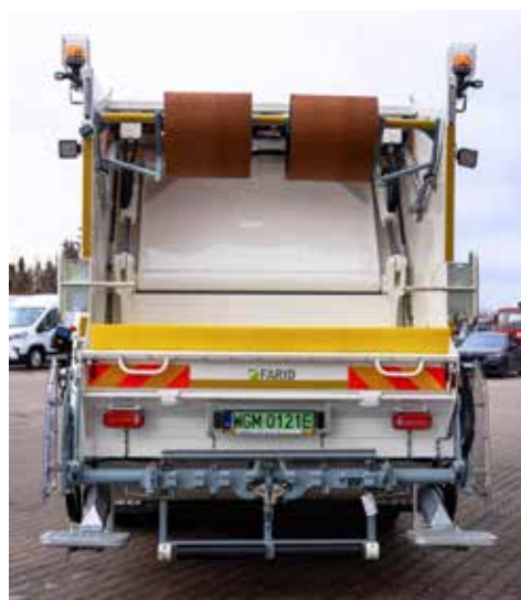
Zabudowa Farid T1 Plus zapewnia maksymalny stopień zgniotu 6:1 i jest przeznaczona do zbierania stałych odpadów komunalnych, surowców wtórnych oraz tzw. wielkogabarytów.
