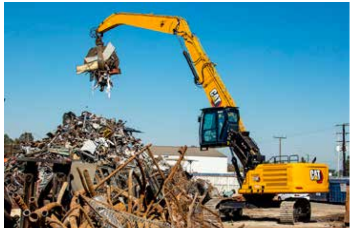
Podwozie gąsienicowe gwarantuje znakomitą stabilność i jest lepiej odporne na wszelkiego rodzaju blachy, pręty czy druty, co w takich aplikacjach nabiera szczególnego znaczenia.
