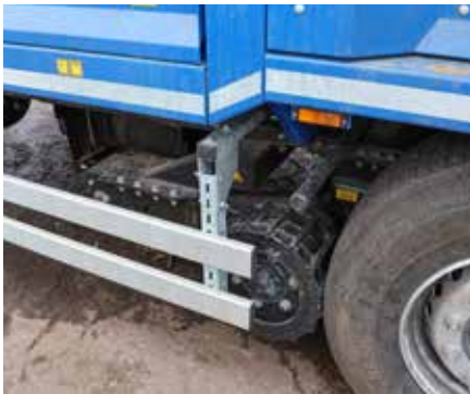
Przy przedniej osi znajdują się ażurowe bębny, które na czas jazdy są dociskane do opon. Każdy z nich jest napędzany osobnym silnikiem hydraulicznym.
