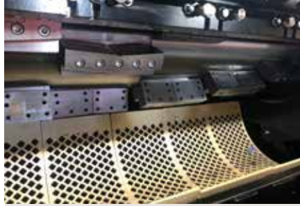
Zależnie od przetwarzanego materiału i zastosowanego sita wydajność wynosi od 10 do 40 t/h. Dzięki systemowi Easy Grid wymiana sita jest szybka i bezpieczna dla obsługi.
