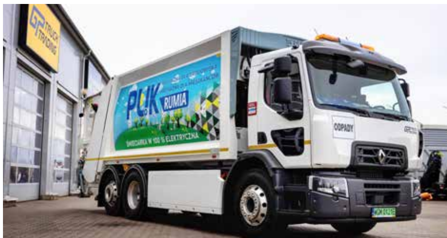
Elektryczna śmieciarka została wyposażona w koła ze stopów lekkich, które ograniczają masę własną pojazdu. Uwagę zwracają też drzwi typu Vision, niezwykle przydatne podczas pracy w gęsto zaludnionych rejonach.
