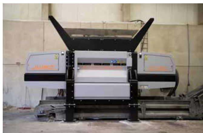
Układ sterowania zapobiega przeciążeniu maszyny, gwarantując ciągłość pracy przy przetwarzaniu szerokiego spektrum materiałów.
