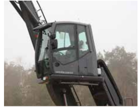
Niemal w całości przeszklona kabina zapewnia znakomitą widoczność we wszystkich kierunkach. Przednia szyba oraz dach mogą być zabezpieczone fabrycznymi osłonami.
