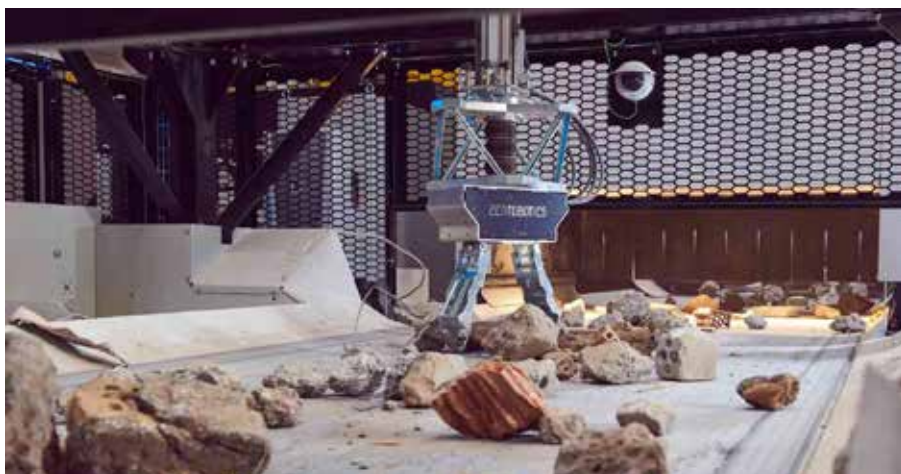
Robot sortujący Zen Robotics serii Heavy Picker jest w stanie podejmować przedmioty o masie do 30 kg. Jego skuteczność w wysortowywaniu frakcji pozytywnych wynosi aż 99%.
