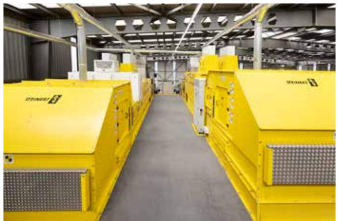
Promieniowanie rentgenowskie pozwala oddzielić produkty z czystego aluminium (po prawej), system STEINERT KSS XF - CLI z fluorescencyjną rentgenowską oddziela produkty z miedzi, mosiądzu i cynku.
