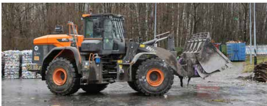
Nowa maszyna Doosan DL420 jest napędzana 6-cylindrowym silnikiem rzędownym Scania DC13 o mocy 257 kW (345 KM), który w porównaniu do jednostki stosowanej w ładowarce poprzedniej generacji zapewni niższe zużycie paliwa o 5%.
