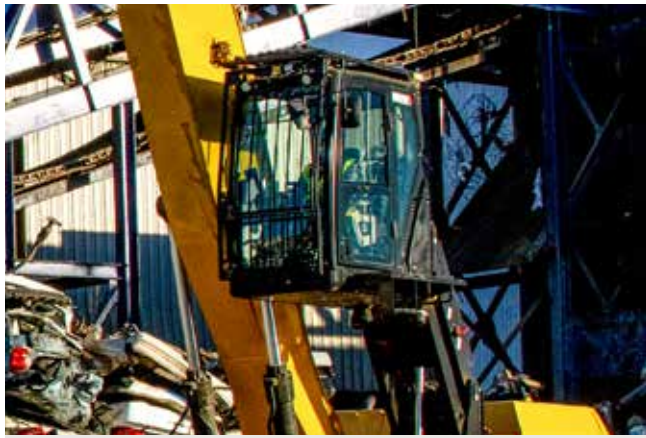
Przednia szyba jest wykonana z grubego szkła laminowanego odpornego na uderzenia, które spełnia wymagania klasy P5A. Tuż przed nią oraz nad dachem zamontowano solidne kraty stanowiące dodatkowe zabezpieczenie przed większymi i cięższymi przedmiotami.
