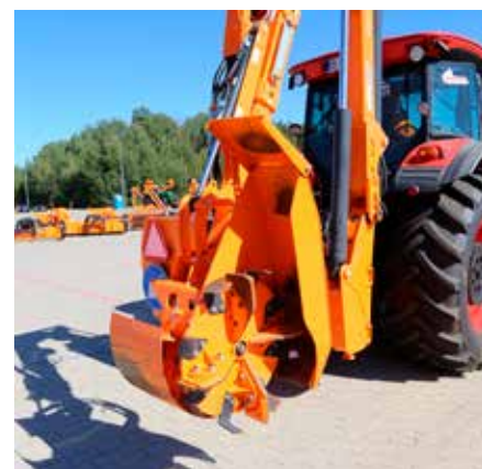
Odmularka do rowów to jedno z wielu narzędzi roboczych marki SaMASZ, które zostały opracowane do współpracy z ramionami wysięgnikowymi.
