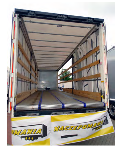
W PTM wdrożono instalowane we wnętrzu naczep taśmociągi Cargomatic umożliwiające przeładunek kompletu palet w 1,5 minuty, np. przy przewozie produktów z zakładu do pobliskiego magazynu.
