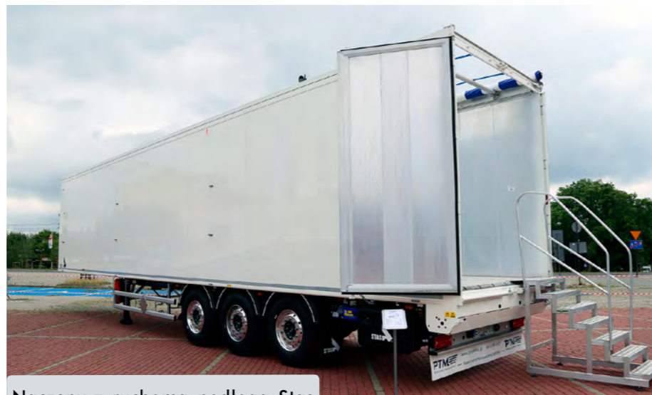
Naczepy z ruchomą podłogą Stas o pojemności 92 m 3 na ramie aluminiowej stanowią zdecydowaną większość sprzedaży PTM. Poza opcjami oferowanymi przez producenta można uzupełnić je o autorskie opracowania, np. płytę zagęszczającą sypki ładunek.
