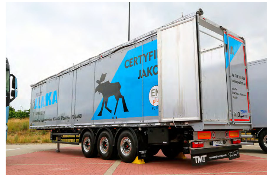
Włoskie naczepy z ruchomą podłogą TMT Conchiglia stanowią uzupełnienie pojazdów Stas . Ta ma otwieraną boczną ścianę, co umożliwi przeładunek palet lub big-bagów , ale ze słupkiem pośrodku. TMT ma też model otwierany „na oścież”.
