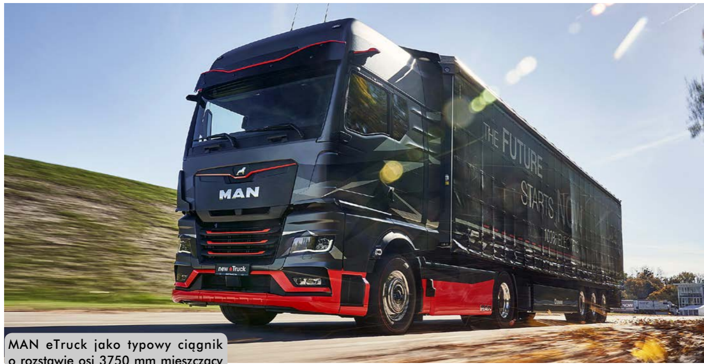
Górna i boczne owiewki kabiny MAN TGX dostały elastyczne końcówki przymykające szczelinę między kabiną a naczepą/zabudową. Zmniejszają się dzięki temu zawirowania pochłaniające energię. Lusterka zewnętrzne zastąpiono układem MAN OptiView.
