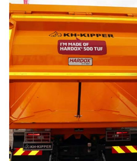
W wielu pojazdach na Baume wykorzystano blachy ze stali HARDOX 500 Tuf, czym szczycili się ich producenci. Była wśród nich kopalniana wywrotka tylnosypowa typu W1MV KH-KIPPER. W skrzyni tej wielkości przejście z HX450 na Tuf umożliwia zmniejszenie masy własnej o kilkaset kg, a także mniejszą pracochłonność wykonania, w tym spawania.
