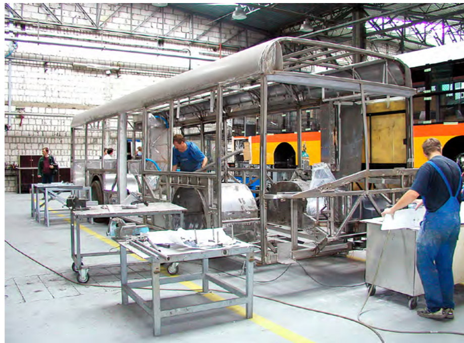
Produkcja Urbino w Bolechowie, tak jak to wyglądało w 2002 r. Szkielet autobusu był wykonany z profili ze stali o zwiększonej wytrzymałości i odporności na korozję, o dużych przekrojach, by uzyskać sztywną konstrukcję niewrażliwą na drgania przenoszone z nierówności nawierzchni.
