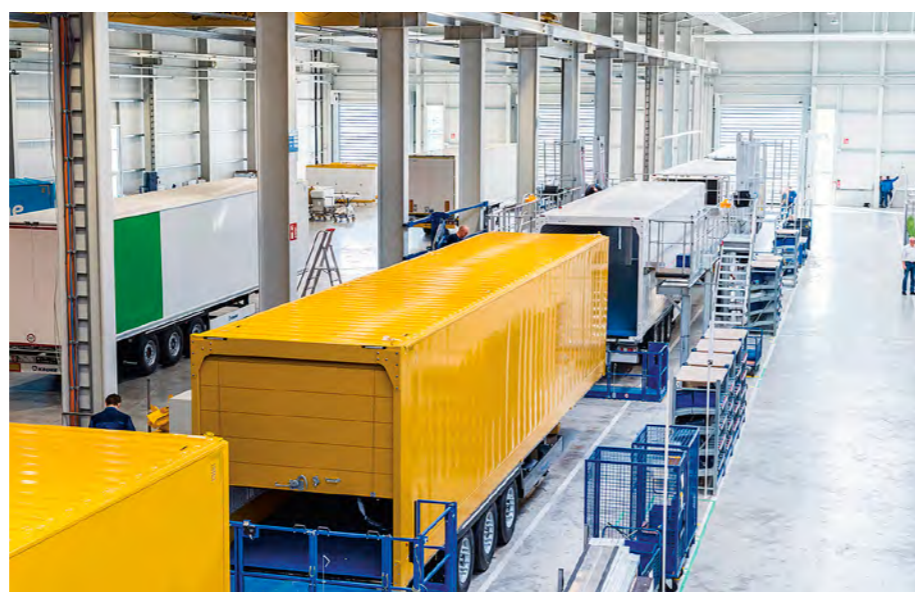
Jedna z dwóch nowych linii produkcyjnych Dry Liner, z nadwoziami „STG” (Stalowa ściana Gładka). (fot. Krone)
