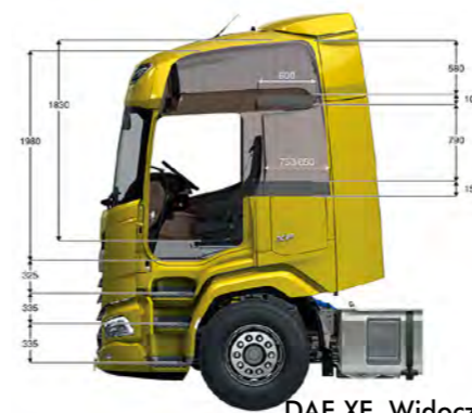
DAF XF. Widoczne są wielkie promienie zaokrąglenia narożników kabiny, na ścianie przedniej praktycznie nie ma płaskiej powierzchni do spiętrzenia ciśnienia.
