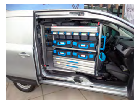
Pierwsze specjalistyczne zastosowanie Open Sesame to samochód warsztatowy z obracającym regałem, dostępnym z boku po złożeniu fotela pasażerskiego i obróceniu przegrody
