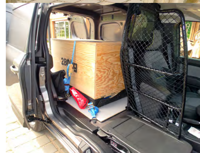
Fotel pasażera składa się do płaskiej podłogi, a przy wykorzystaniu dwóch zaczepów do mocowania uzyskujemy dodatkową przestrzeń na bezpieczny przewóz ładunku w kabinie.
