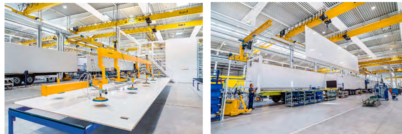
Panele o długości do 13,6 m, wykonane ze sklejki, tworzywa sztucznego lub warstwowe, są wstawiane jako całość na stanowiska montażu nadwozi (fot. Krone).
