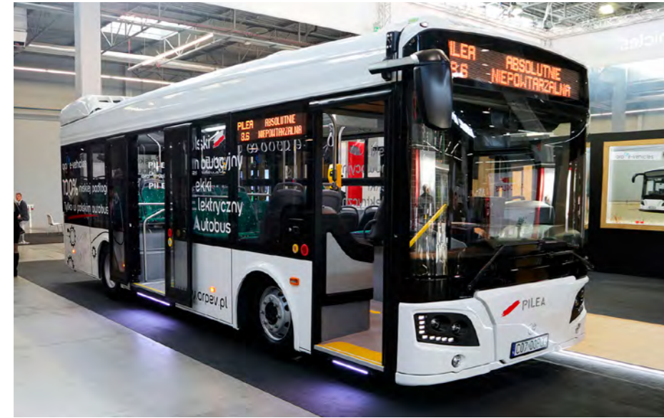
Pileta 8,6 m jest całkowicie niskopodłogowa, płaskie baterie trakcyjne opracowane przez Impact specjalnie do tego modelu umieszczone w podestach foteli. Dodatkową korzyścią jest wysokość całkowita jedynie 3,2 m.
