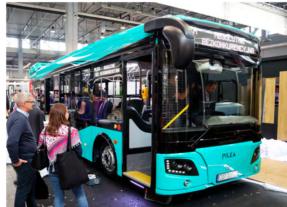
Pileta 8,6 m jest całkowicie niskopodłogowa, płaskie baterie trakcyjne opracowane przez Impact specjalnie do tego modelu umieszczone w podestach foteli. Dodatkową korzyścią jest wysokość całkowita jedynie 3,2 m.
