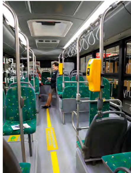
Pileta 8,6 m jest całkowicie niskopodłogowa, płaskie baterie trakcyjne opracowane przez Impact specjalnie do tego modelu umieszczone w podestach foteli. Dodatkową korzyścią jest wysokość całkowita jedynie 3,2 m.
