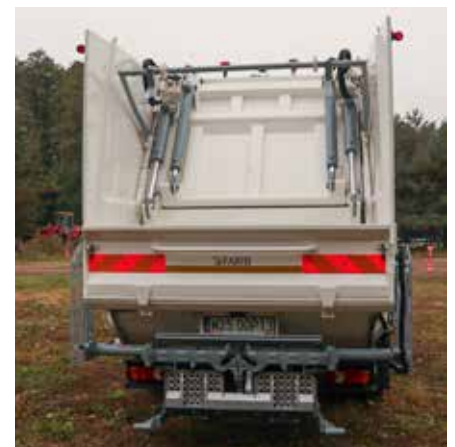
Podczas wyładunku prasa jest unoszona, a odpady wygarnia z wanny ładunkowej teleskopowana płyta oporowo-wypychająca.
