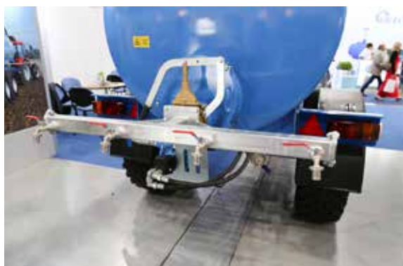
Do dystrybucji wody pitnej np. podczas awarii wodociągu służy belka czerpalna z kranami.
