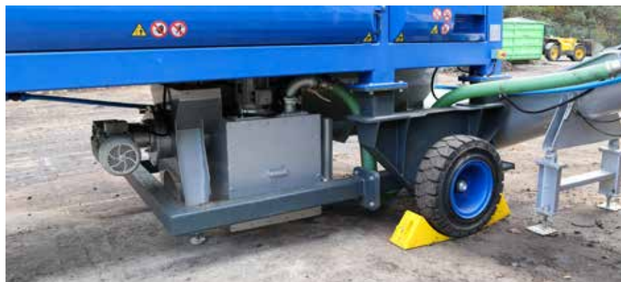
W dualnym systemie wyładunku frakcja sucha jest odprowadzana spod maszyny za pomocą przenośnika śrubowego, natomiast mocno uwodniona przy użyciu pompy.
