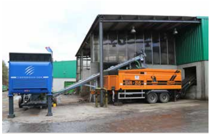
W ZUK Puławy separator Tiger Depack HS10 współpracuje z mikserem Doppstadt DM 215. Obie maszyny są mobilne, dzięki czemu taki ciąg technologiczny może pracować w różnych częściach zakładu.
