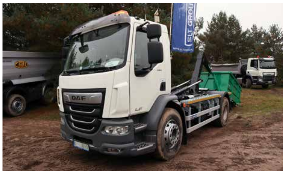
Niska podłoga kabiny i dobra widoczność z miejsca kierowcy w LF przydają się także przy obsłudze kontenerów hakowych. Na tym podwoziu firma SLT zamontowała 12-tonowe urządzenie hakowe HKS 12.40 do kontenerów KP-7 i KP-10 o długości do 4500 mm.
