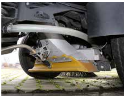
Najnowsze zmiatarki serii CityCat V20 wyróżnia m.in. unikatowe zawieszenie ssawy, które chroni ten newralgiczny element podczas przejazdów przez przeszkody. Wlot ma szerokość 650 mm.
