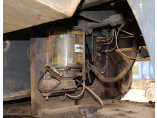
Intensywną eksploatację prasożyc ułatwia montowany standardowo układ centralnego smarowania.
