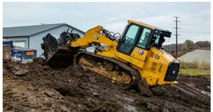
Ładowarka gąsienicowa pozwala na nabranie urobku w łyżkę i przewiezienie go w inne miejsce. Funkcja ta przydaje się m.in. podczas dokładnego wyrównywania składowiska, budowy warstw przesypanych czy obwałowań.
