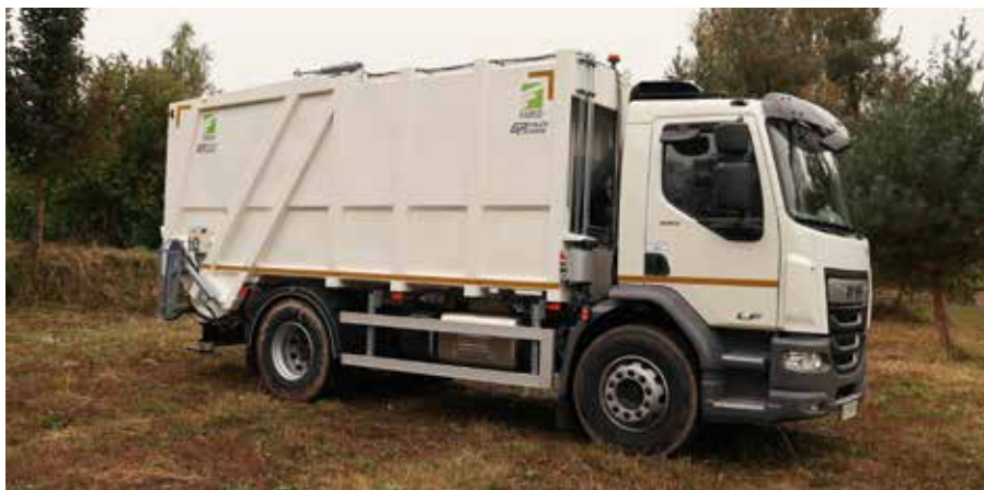
Zwinne śmieciarki na 2-osiowych podwoziach DAF LF są znane m.in. warszawiakom. Ta jest jednak nietypowa: nie ma podnoszonego odwłoka. Dzięki temu jest całkowicie szczelna i można odbierać nią bioodpady.
