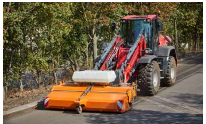
Oprócz prac typowo załadunkowych ładowarki Weidemann serii 90 mogą być z powodzeniem wykorzystywane do zadań związanych z utrzymaniem dróg, np. zamywania czy odgarniania śniegu.
