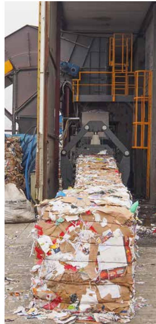
W belownicy HSM VK 12018 zastosowano wiązanie poziome 5-krotne. Nawet przy prasowaniu najtwardszych tworzyw nie dochodzi do pęknięcia bel. Na zdjęciu pierwsza maszyna HSM zakupiona przez Karnowski Recykling.
