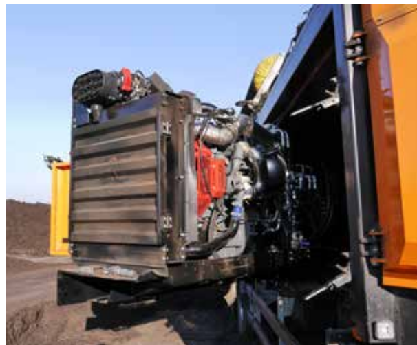
Trudno wyobrazić sobie lepszy dostęp do silnika. Jest on osłonięty jednoczęściową, szeroko otwieraną pokrywą i co najważniejsze można go wystawić poza obudowę maszyny. W ten sposób uzyskuje się do niego dostęp z obu stron.
