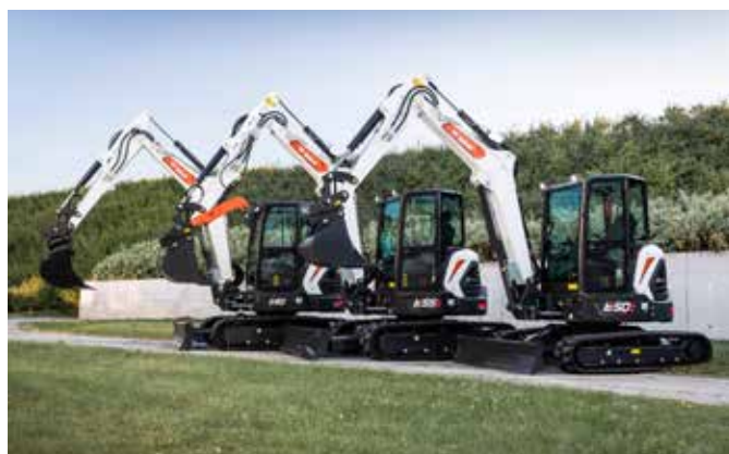
Nowe minikoparki klasy 5-6 t serii R2 spełniają normy emisji spalin Stage V. W dwóch modelach, tj. E50z, E55z podczas obrotu nadwozie nie wystaje poza obrys maszyny.
