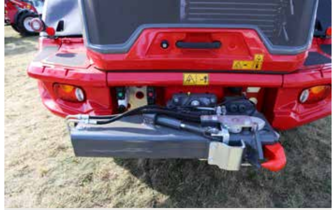
Obie ładowarki serii 90 mogą być wyposażone w wiele praktycznych opcji. Wśród nich jest np. obracany zaczep pozwalający zachować nominalny prześwit.
