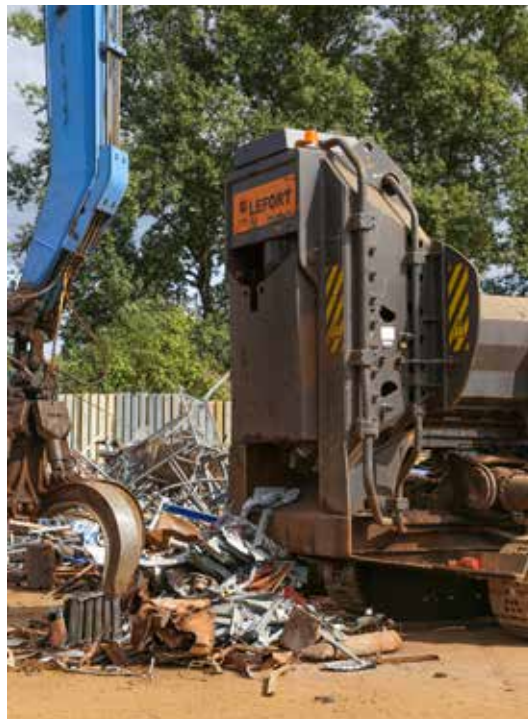
W prasonożycach Lefort można regulować długość cięcia złomu co 10 cm, co ułatwia dopasowanie materiału do wymagań odbiorcy.
