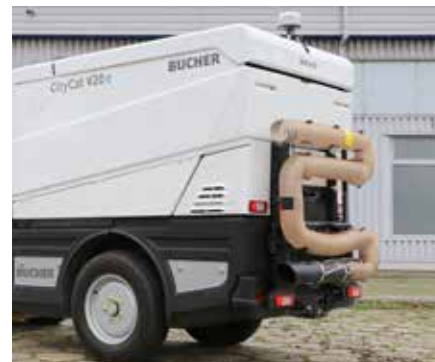
Taka zmiatarka może pełnić rolę dużego odkurzacza, np. do zbierania liści. W tym celu na tylnej ścianie jest montowana rura ssąca o średnicy 120 mm i długości niemal 5 m.
