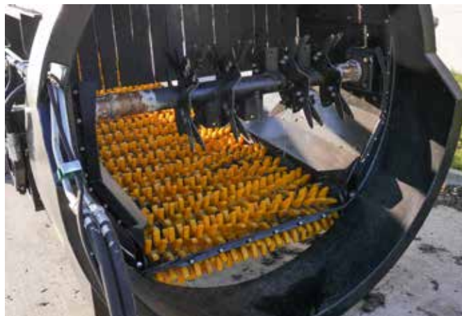
Wyjęty z maszyny pokład gwiazdzisty stosowany zamiennie z sitami bębnowymi. Jego zasadniczą część stanowi kilkaset poliuretanowych gwiazdek, które uginają się w kontakcie z twardymi elementami i dzięki temu są odporne na uszkodzenia mechaniczne.
