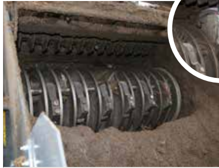
W modelu TBG 620 wał jest wyposażony w 28 wahliwych młotków, każdy ma masę 16 kg. Element tnący może być wykorzystany 2-krotnie – po obróceniu o 180°. Czynność ta jest bardzo łatwa, ponieważ wystarczy odkręcić dwie śruby.
