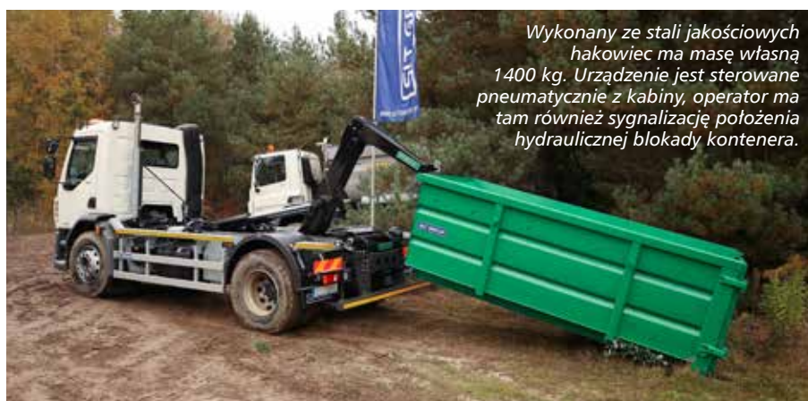
Niska podłoga kabiny i dobra widoczność z miejsca kierowcy w LF przydają się także przy obsłudze kontenerów hakowych. Na tym podwoziu firma SLT zamontowała 12-tonowe urządzenie hakowe HKS 12.40 do kontenerów KP-7 i KP-10 o długości do 4500 mm.
