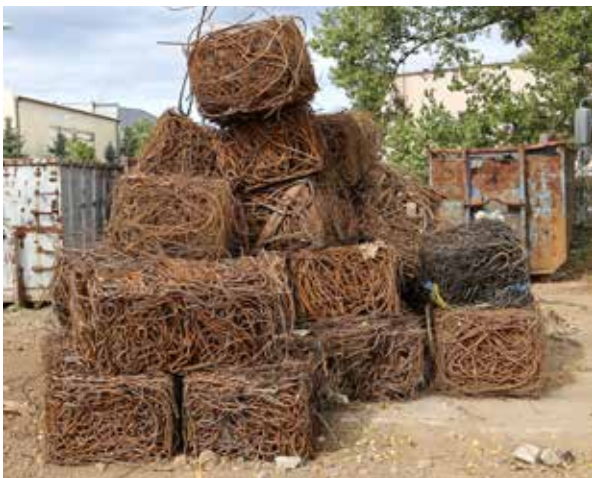
Efekt pracy prasożyc Lefort Trax 600 w trybie paczkowania. Drut o różnej grubości, w tym żebrowy, który jest sprasowany w prostopadłościąny łatwo magazynować i transportować.
