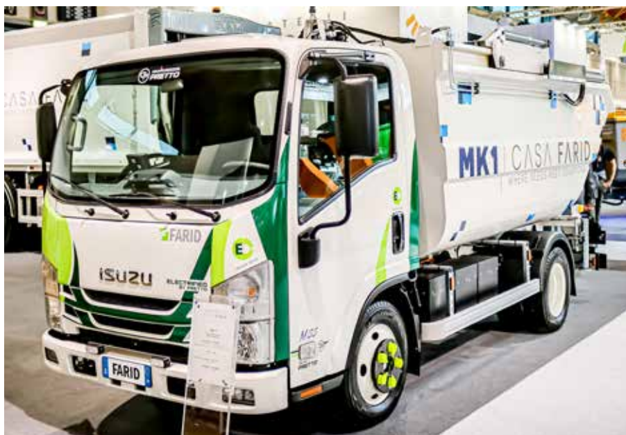
Isuzu M55 zelektryfikowany przez Pretto i z zabudową Farid na ubiegłorocznych targach Ecomondo. Konwersję ułatwiło porozumienie obu firm dotyczące gwarancji.
