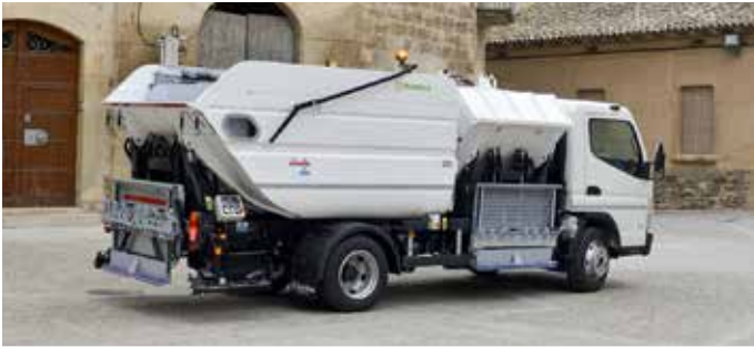
W zabudowie ORUS COMBI TD komora znajdująca się za kabiną nie ma mechanizmu zagęszczającego, dlatego jest przeznaczona do odpadów, których nie powinno się lub nie można zagęszczać, np. bioodpady czy szkło.
