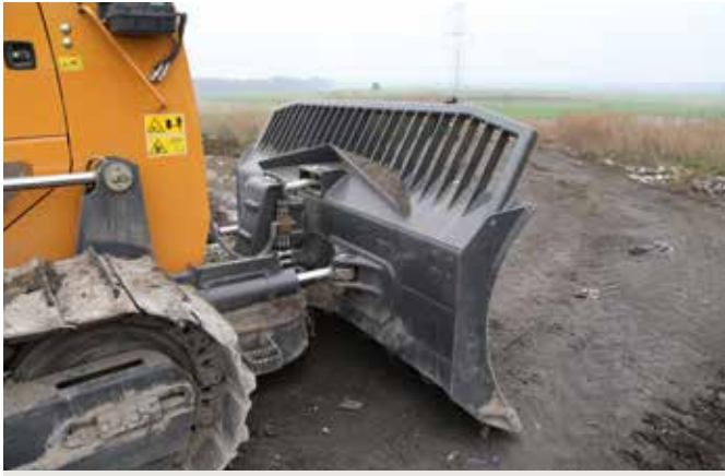
Model 1150M występuje tylko z mocowanym centralnie, 6-pozycyjnym lemieszem typu PAT. Krata nad lemieszem zwiększa jego pojemność i zapobiega przesypaniu odpadów na siłowniki.
