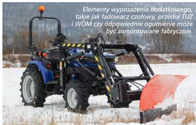
Ciągniki FARMTRAC zostały zaprojektowane do pracy z ładowaczami. Zastosowanie przedniej osi o dużej nośności pozwala na bezpieczne wykonywanie prac załadunkowych i transportowych różnych materiałów, zarówno sypkich, jak i spaleczonych.
