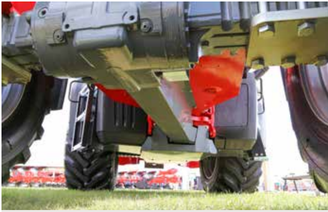
Wał napędowy został zabezpieczony solidną osłoną, która skutecznie zapobiega przed nawijaniem się na niego różnych drutów, sznurków, kawałków folii, jakie często można spotkać podczas pracy z odpadami.
