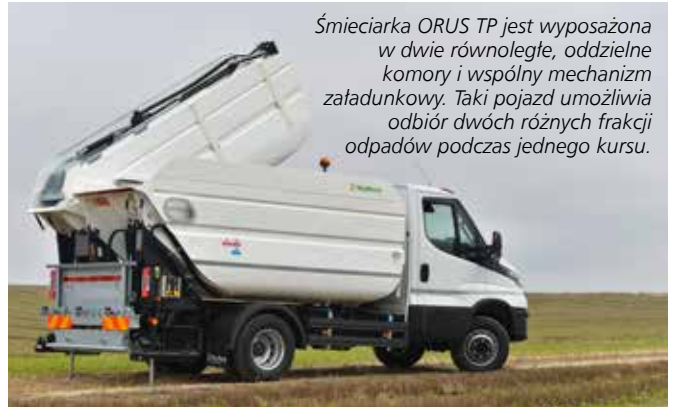
W zabudowie ORUS COMBI TD komora znajdująca się za kabiną nie ma mechanizmu zagęszczającego, dlatego jest przeznaczona do odpadów, których nie powinno się lub nie można zagęszczać, np. bioodpady czy szkło.
