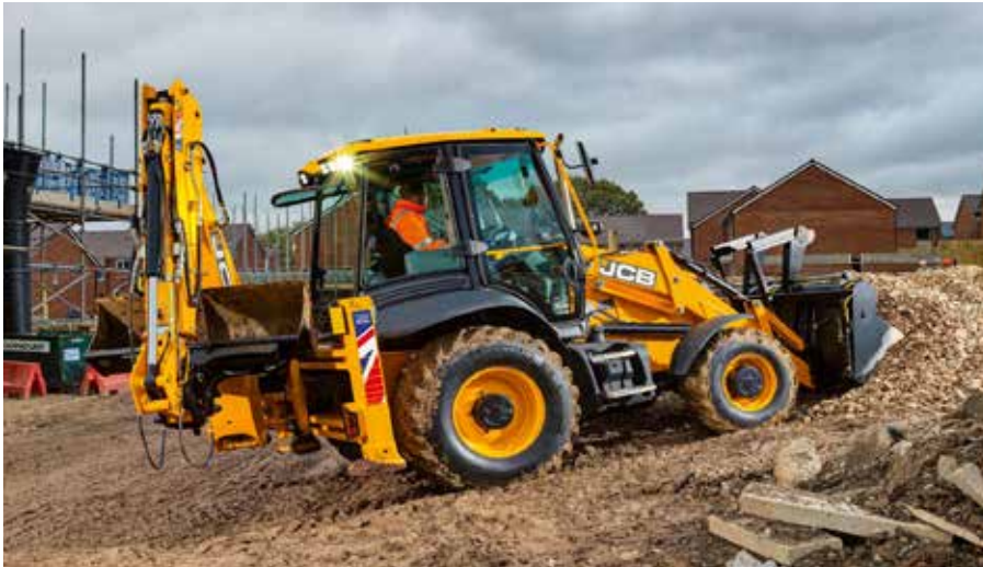
Nowy model 3CX wyróżniają: ulepszona kabina, bezpieczna obsługa (w tym zintegrowane światła ostrzegawcze LED i oświetlenie stopni), duża sprawność dzięki 3-litrowemu silnikowi Stage V, a także wydajność zawdzięczana automatycznemu poziomowaniu, przełączaniu sterowania wraz z obrotem fotela i zmianie napędu na 2 lub 4 koła.
