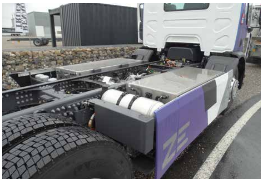
Baterie trakcyjne i ich obudowa muszą przejść próby potwierdzające wymaganą przez przepisy odporność na uszkodzenia mechaniczne, ogień, drgania. Ogniwa litowo-jonowe wymagają stabilnej temperatury, zużywając część swojej energii na jej utrzymanie, w czasie pracy dzielą się swoim ciepłem z załogą śmieciarki.
