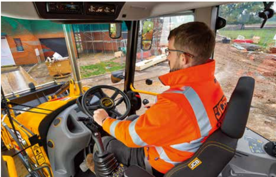
W kabinie Command Plus operator ma doskonałą widoczność na osprzęt i otoczenie maszyny. Wszystkie uchwyty są pomalowane na żółto, aby można je było szybko zauważyć.
