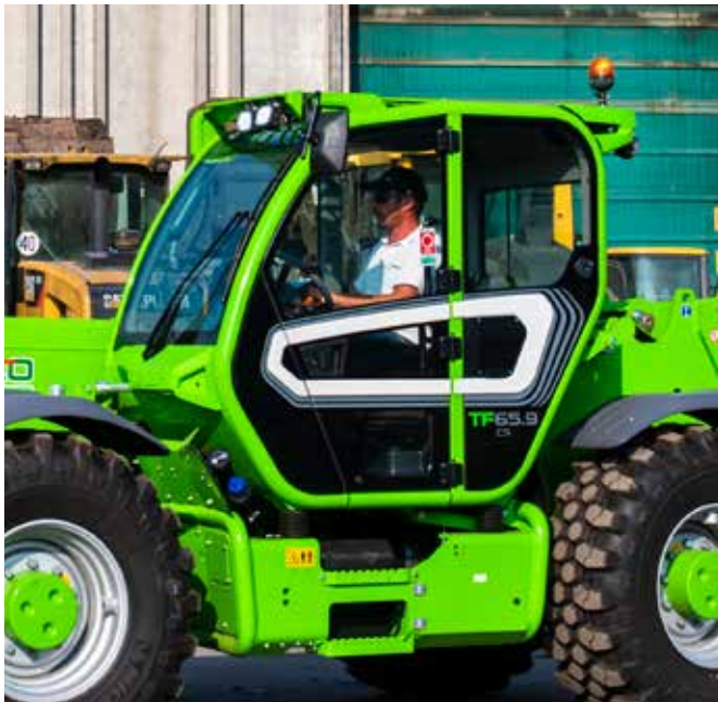
Ładowarka Merlo TF65.9 może być wyposażona w układ amortyzacji kabiny, który ogranicza hałas i drgania docierające do operatora.
