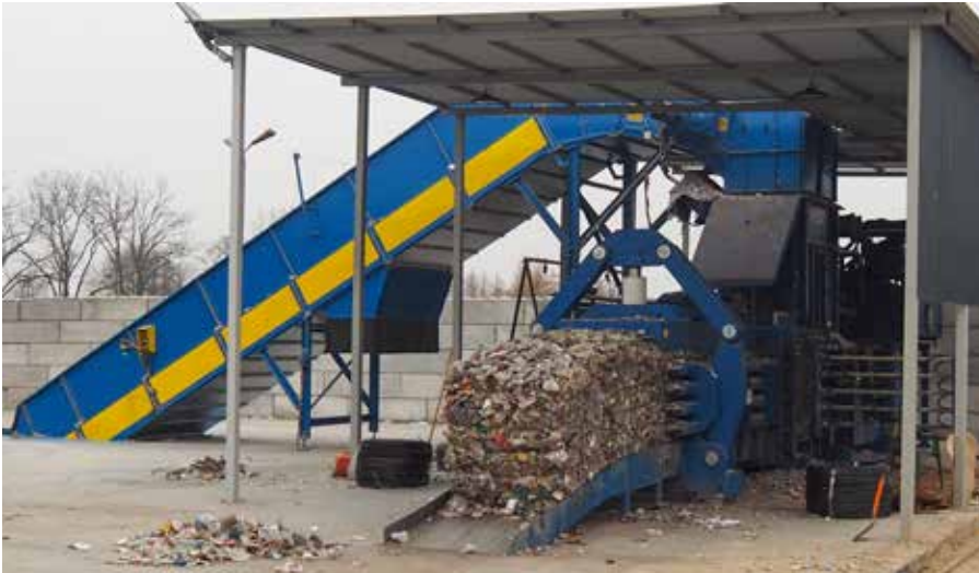
Druga, niedawno zakupiona belownica HSM VK 12018 to maszyna używana i bez przetwornicy częstotliwości. Nie ma jednak dla niej taryfy ulgowej – jest tak samo intensywnie eksploatowana, co młodsza jednostka ze sterowaniem FU.
