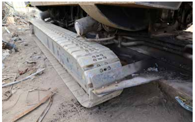
Po jednej stronie gąsienic znajdują się masywne zgarniacze, które zapobiegają przedostaniu się w strefę siłowników np. prętów, drutów czy blach mogących uszkodzić przewody hydrauliczne.
