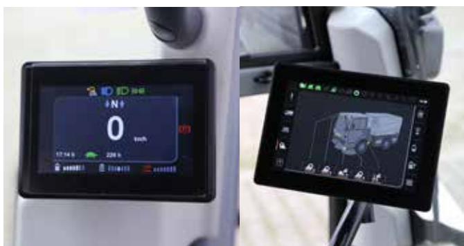
Każda zmiatarka serii V20 może być wyposażona w dwa wyświetlacze (od lewej): Smart-Con o przekątnej 4,3" i 10,1-calowy, dotykowy CSense.
