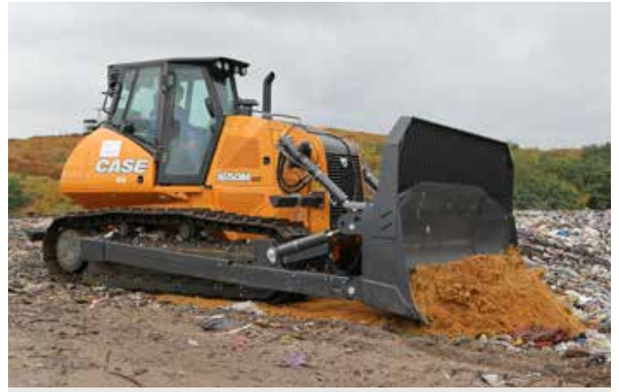
Spycharka średnia 1650M i największa 2055M może być wyposażona w lemiesz typu „Buldożer”, a więc z bocznymi wspornikami. Do wyboru jest ponadto wersja prosta lub półwklęsta Semi-U.
