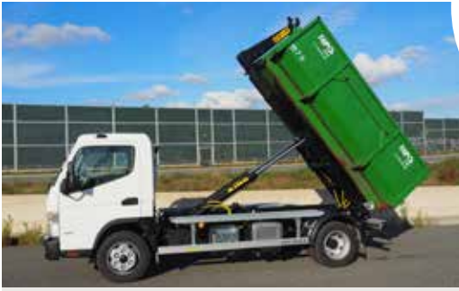
Funkcja wywrotki służąca do opróżniania kontenera na wysypisku lub w sortowni. Dwa siłowniki hydrauliczne pracują pod ciśnieniem roboczym 25 MPa.
