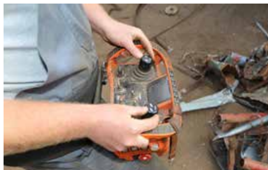
Dzięki pilotowi prasonożyc może obsługiwać operator maszyny przeładunkowej. Takie sterowanie jest też bardzo wygodne przy przemieszczaniu sprzętu, ponieważ można go kontrolować z dowolnej strony. W pilocie znajduje się ekran pokazujący parametry pracy maszyny.
