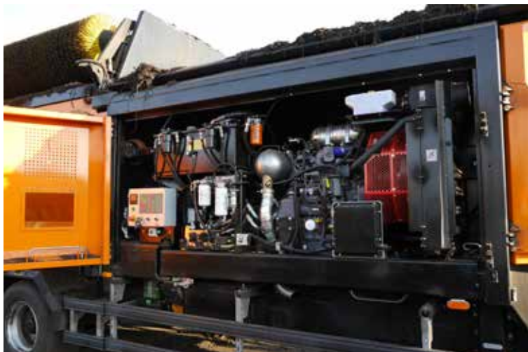
Trudno wyobrazić sobie lepszy dostęp do silnika. Jest on osłonięty jednoczęściową, szeroko otwieraną pokrywą i co najważniejsze można go wystawić poza obudowę maszyny. W ten sposób uzyskuje się do niego dostęp z obu stron.
