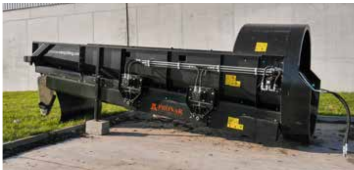
Wyjęty z maszyny pokład gwiazdzisty stosowany zamiennie z sitami bębnowymi. Jego zasadniczą część stanowi kilkaset poliuretanowych gwiazdek, które uginają się w kontakcie z twardymi elementami i dzięki temu są odporne na uszkodzenia mechaniczne.
