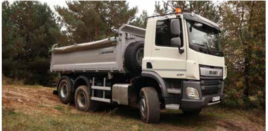
Trójstronna wywrotka KH-KIPPER na budowlanym DAF-ie CF. Podwozia serii Construction wyróżniają się kątem natarcia 25° i prześwitem 40 cm pod przednią, prostą osią. Widoczny jest duży skok zawieszenia mostów, ułatwiający przeniesienie siły napędowej na nierówny teren.
