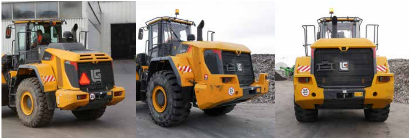
Po lewej ładowarka LiuGong 856H Stage IV, w środku i po prawej w wersji Stage V, która trafiła do firmy FBSerwis Wrocław. Łatwo je rozróżnić: nowa maszyna ma niższy profil pokrywy silnika, a ponadto wstępny filtr powietrza oraz tłumik są umieszczone w jednej linii. Te zmiany w wymierny sposób przyczyniły się do poprawy widoczności do tyłu. Nieco inna jest też przeciwwaga, która wyróżnia się charakterystycznymi „skrzydełkami”.
