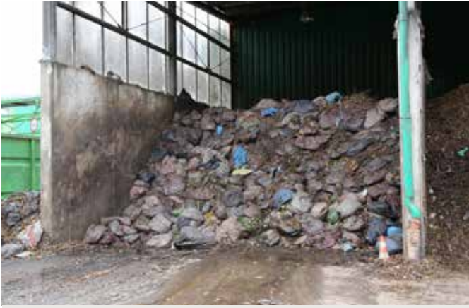
Puławski zakład wiąże duże nadzieje z maszyną Tiger, bo choć udział odpadów „bio” stale rośnie, to są one dostarczane w plastikowych workach, które utrudniają produkcję wysokiej jakości kompostu.
