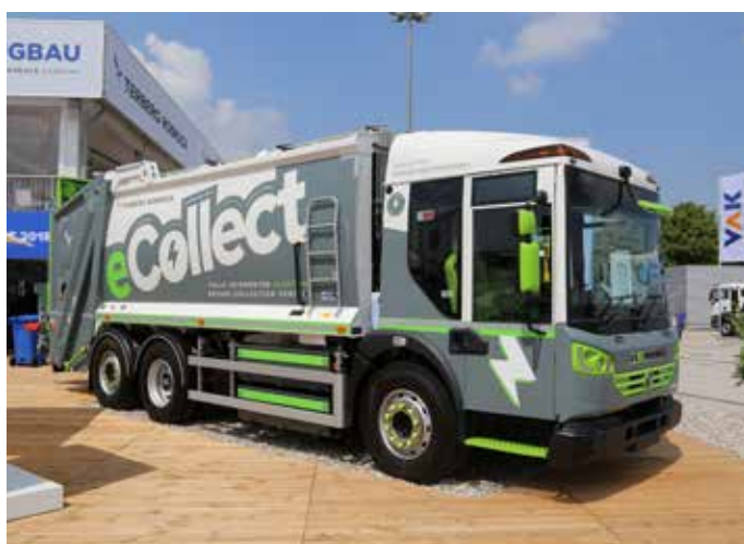
Konstruktorzy Dennis Eagle ulokowali jeden pakiet baterii litowo-jonowych i całą elektronikę pod kabiną w miejsce silnika spalinowego, po obu stronach ramy znalazły się kolejne 4 baterie, a między nimi silnik elektryczny przekazujący napęd krótkim wałem na tylny most. eCollect jest obecnie oferowany z hydraulicznym mechanizmem załadunkowym Terberg, ale przeprowadzono próby z elektrycznym i przyszłość pokaże, który wygra. Cała śmieciarka jest prostsza niż spalinowa, ma mniej ruchomych i zużywających się części, odpada wiele czynności obsługowych, a do tych wymagających kwalifikacji producent przygotowuje serwis klienta. W 2022 r. eCollect będzie oferowany także na naszym rynku.
