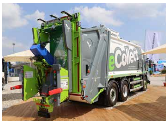
Konstruktorzy Dennis Eagle ulokowali jeden pakiet baterii litowo-jonowych i całą elektronikę pod kabiną w miejsce silnika spalinowego, po obu stronach ramy znalazły się kolejne 4 baterie, a między nimi silnik elektryczny przekazujący napęd krótkim wałem na tylny most. eCollect jest obecnie oferowany z hydraulicznym mechanizmem załadunkowym Terberg, ale przeprowadzono próby z elektrycznym i przyszłość pokaże, który wygra. Cała śmieciarka jest prostsza niż spalinowa, ma mniej ruchomych i zużywających się części, odpada wiele czynności obsługowych, a do tych wymagających kwalifikacji producent przygotowuje serwis klienta. W 2022 r. eCollect będzie oferowany także na naszym rynku.
