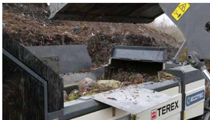
Bęben podający materiał ma szerokość 1500 mm. W najwyższej pozycji zapewnią prześwit wynoszący 450 mm.
