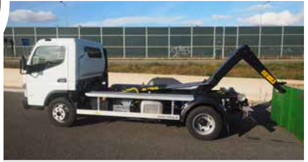
7,5-tonowe, zwarte podwozie Fuso Canter oparte na wytrzymałej ramie idealnie nadaje się do pracy z urządzeniem hakowym. Przeciężenia są wpisane w ten zawód.
