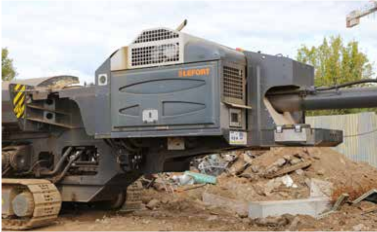
Komora silnikowa znajduje się po przeciwnej stronie co zespół tnący, zapewniając prawidłowy rozkład masy i tym samym odpowiednią stabilność maszyny.
