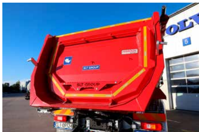
Tylna burtta otwierana automatycznie jest przystosowana do współpracy z rozścielaczem asfaltu. Są dostępne także inne zamknięcia skrzyni wg potrzeb użytkownika.
