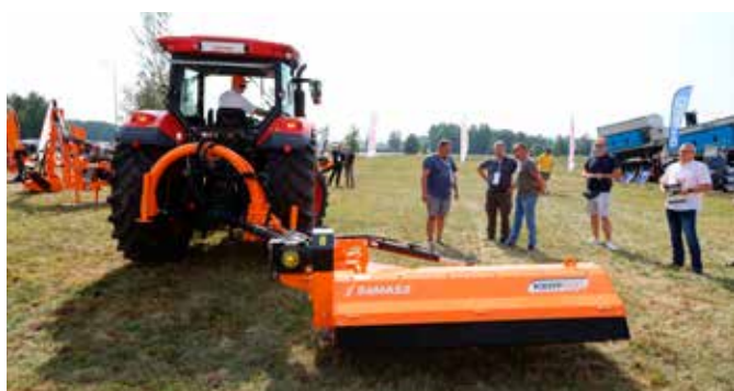
Kosiarka KBRP-200 ma szerokość roboczą 2 m, a wysięgnik pantografowy umożliwi pochylecie głowicy pod kątem od -60 do 90° w celu koszenia skarp czy zboczy.
