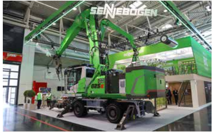
Zestaw akumulatorów znajduje się z tyłu maszyny, pełniąc rolę naturalnej przeciwwagi.
