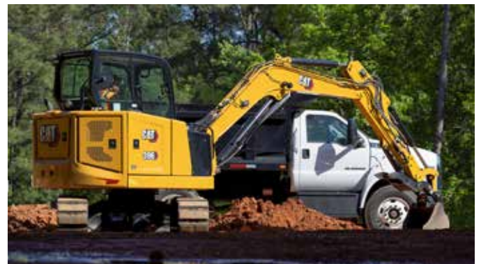
W największych maszynach gąsienice stalowe występują w wersji z gumowymi nakładkami, chroniącymi nawierzchnię przed uszkodzeniem.
