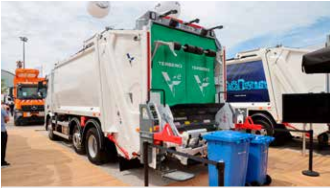
Jeśli tylny załadunek odpadów, to wrzutnikiem OmniMAX-E napędzonym własnym układem elektrohydraulicznym zasilanym z instalacji 24 V. Rozwiązanie to jest szczególnie przydatne przy podwoziach elektrycznych, a także w śmieciarkach z systemem start-stop.
