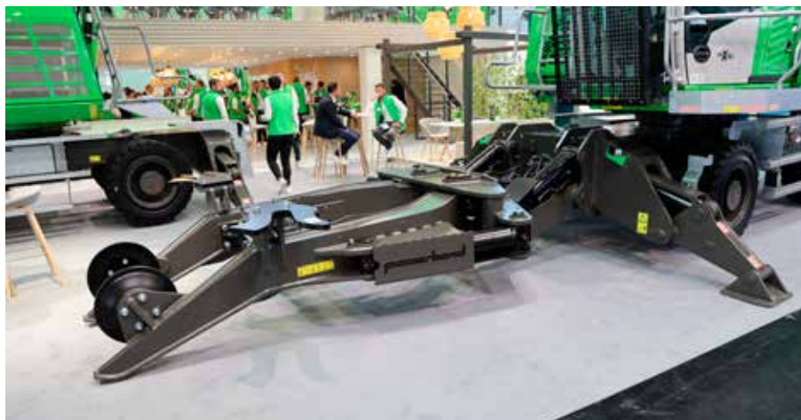
Specjalne ramiona umożliwiają pewne przytrzymanie samochodu, dzięki czemu bez problemu można z niego wyrwać fotele, silnik czy osie.
