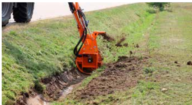
Korzystając z głowicy odmulającej OR 080 można szybko oczyścić przydrożny rów, ułatwiając odpływ wody np. podczas wiosennych roztopów.
