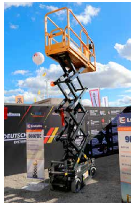
Model otwierający gamę podnośników nożycowych to LSC0607DE o zwartych wymiarach ułatwiających pracę we wnętrzu nawet małych hal, lekkim i łatwym do przemieszczania między obiektami, a przy tym umożliwiającym bezpieczną pracę dwóch osób ze sprzętem w koszu podniesionym na wysokość 5,8 m.
