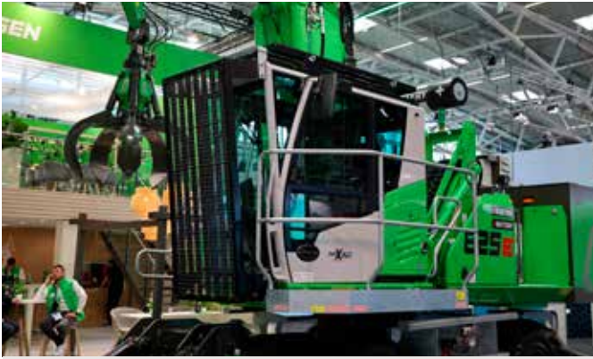
Przy takich aplikacjach warto zabezpieczyć przednią szybę; na skutek naprężenia jakiś element może „wyszczerzyć” w kierunku kabiny, stwarzając zagrożenie dla maszyny i operatora.
