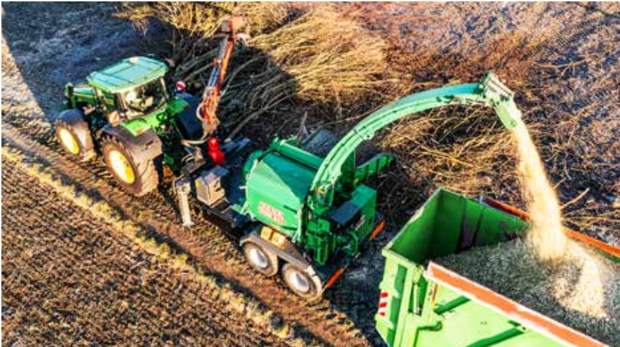
Jeśli zakład posiada odpowiedni ciągnik, a rębarkowanie odbywa się sporadycznie, optymalnym rozwiązaniem może być rębak ciągniony napędzany z WOM.
