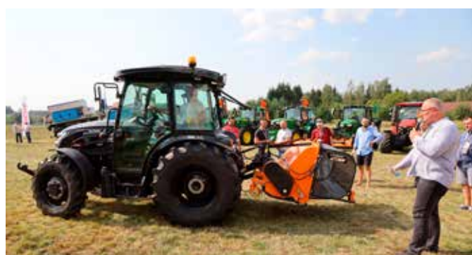
Kosiarka bijakowa Ibis 125 to nowy model w ofercie SaMASZ. Została wyposażona w koła kopiujące i regulację obrotów, co pozwala na dokładne zmulczowanie trawy i zarośli, zbierając pokos do zbiornika o pojemności 900 l.
