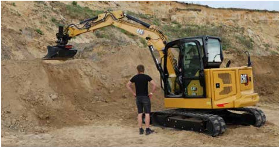
Stosując głowicę uchylno-obrotową każde zadanie może być wykonane dokładniej, szybciej i taniej, bo mniejsza liczba ruchów przekłada się na niższe zużycie paliwa.
