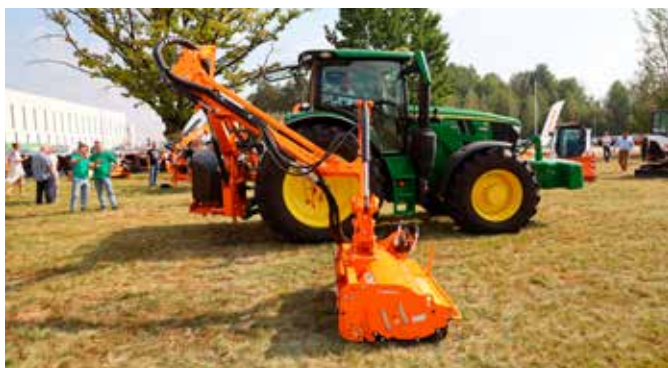
Kosiarka Lama 121HD na ramieniu wysięgnikowym KWT 650 (zasięg 6,5 m). Uwagę zwraca położenie głowicy koszącej na wysokości kabiny, zapobiegając konieczności odwracania głowy do tyłu.
