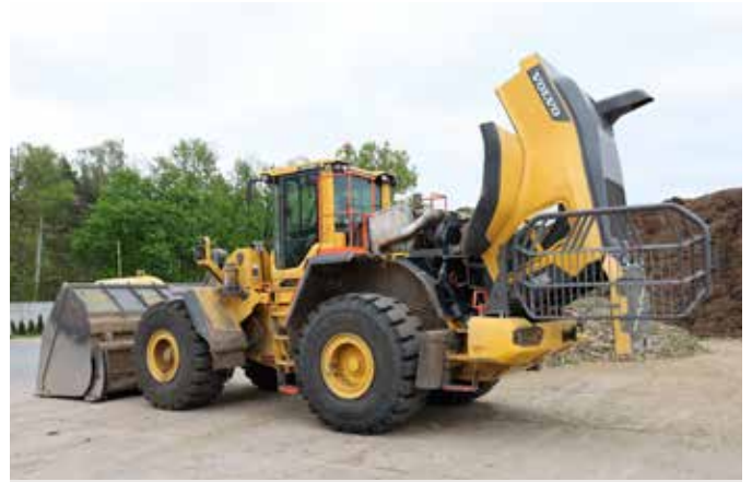
Elektrycznie unoszona pokrywa podnosi się wysoko razem z błotnikami, pozwalając na szybkie uzyskanie wygodnego dostępu do komory silnika. Tylna kratka zabezpiecza układ chłodzenia przed uszkodzeniem.
