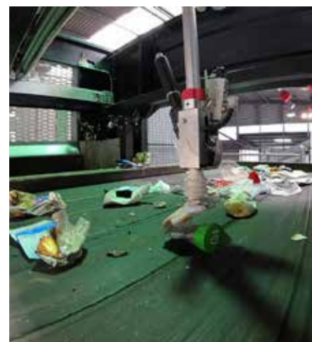
Robot Fast Picker działa na zasadzie przyssawki, w ciągu minuty jest w stanie wykonać nawet 80 pobrań.
