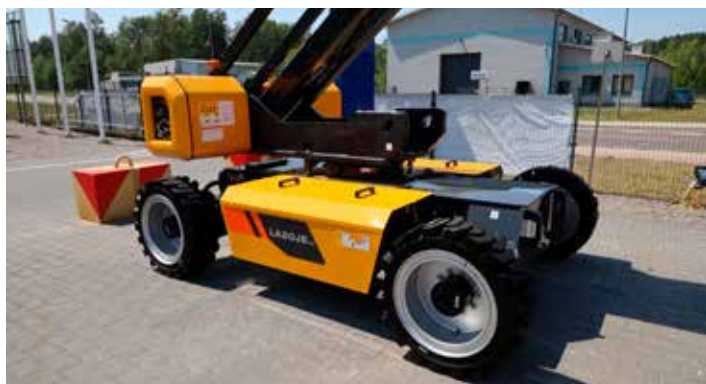
Prześwił podnośnika LA20JE to aż 31 cm, dlatego może on pokonywać pochyłości do 45% i jechać z prędkością do 5 km/h nawet w trudnym terenie.
