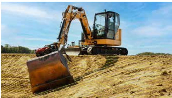
Operatorzy minikoparek Cat mogą korzystać z systemów asystujących E-Fence i Indicate, które wcześniej były dostępne tylko dla dużych maszyn.
