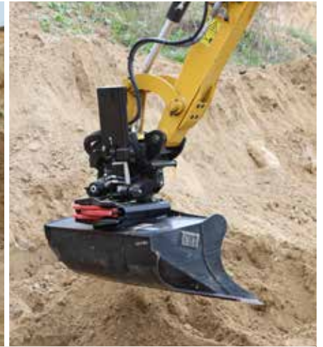
Stosując głowicę uchylno-obrotową każde zadanie może być wykonane dokładniej, szybciej i taniej, bo mniejsza liczba ruchów przekłada się na niższe zużycie paliwa.
