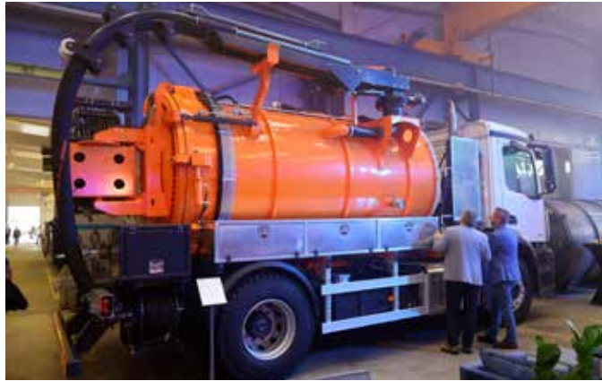
Halę montażową zakładu przekształcono na czas uroczystości w wystawę produktów GP Truck Trading. Dużym zainteresowaniem, wykraczającym poza polski rynek, cieszą się dwufunkcyjne pojazdy do odsysania zanieczyszczeń i mycia kanalizacji.
