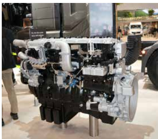
Wodorowy silnik MAN H45 powstał na bazie diesla D38, ma z nim 90% części wspólnych (m.in. cały układ korbowy i smarowanie) oraz takie same rozmiary zewnętrzne, co przyspieszyło wdrożenie i obniżyło koszty rozwojowe. Jest dostępny w pojazdach hTGX o układzie osi 6x4 i 6x2 do specjalnych zastosowań, w których nie udałoby się zapewnić zeroemisyjności w inny sposób. Międzynarodowe jury przyznało za niego nagrodę Innovation Truck of the Year 2025.
