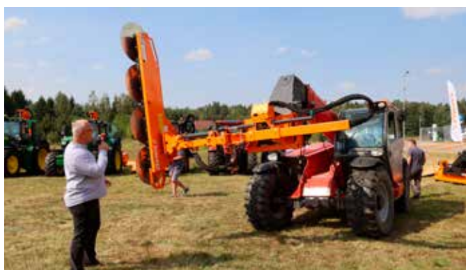
Piła tarczowa PT4-250F służy do przycinania gałęzi o średnicy do 150 mm, a dzięki dużej szerokości roboczej 2,5 m sprawdzi się także przy kształtowaniu wysokich żywopłotów.
