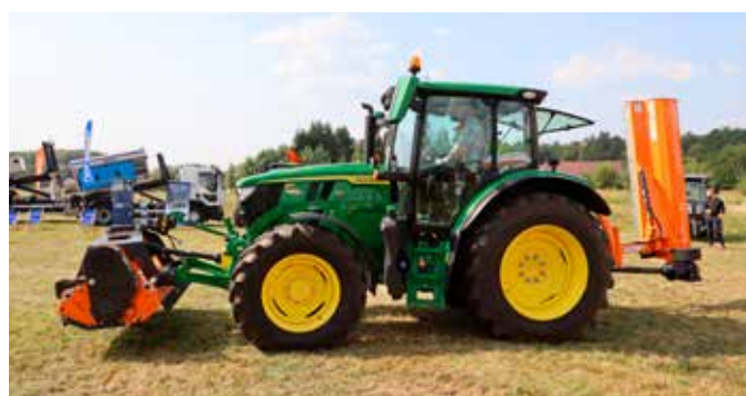
Podwójne koszenie za jednym przejazdem ciągnika: na płaskiej powierzchni przednią kosiarką Grino 200, a na pochyłościach KANGU 220 zamontowaną na pantografie
