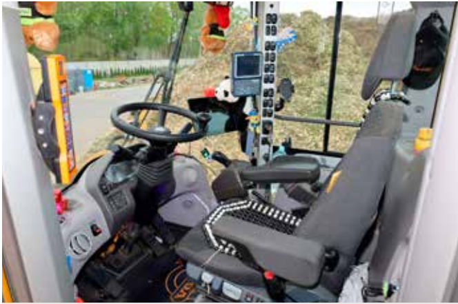
Panoramyczna szyba czołowa zapewnia doskonały widok na obszar roboczy. Starania o odpowiednią widoczność najlepiej widać po bardzo wąskim prawym słupku, na którym udało się jednocześnie zmieścić wiele przycisków, dzięki czemu są w wygodnym dostępie operatora.
