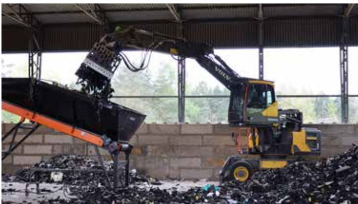
Koparka przeładunkowa pracuje z jednego miejsca, umożliwiając efektywniejsze wykorzystanie miejsca w hali. Podnoszona kabina pozwala na precyzyjny rozkład materiału w koszu załadunkowym.
