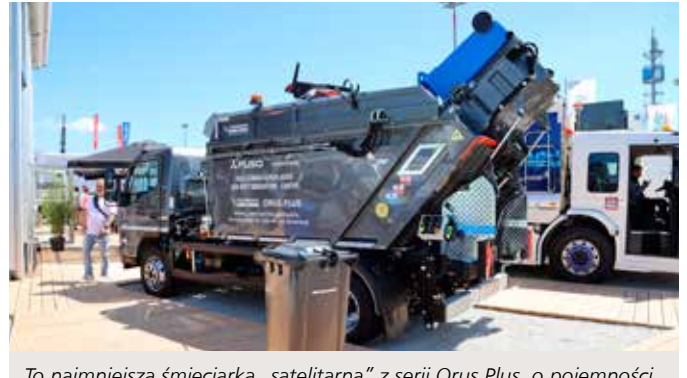
To najmniejsza śmieciarka „satelitarna” z serii Orus Plus, o pojemności 7 m 3 . Zdolna do obsługi najciaśniejszych rejonów, rozładowuje się bezpośrednio w instalacji komunalnej lub do kontenera czy innej, większej śmieciarki. Pojazdy tej wielkości są najłatwiejsze do elektryfikacji, stąd bateryjne podwozie Fuso eCanter.
